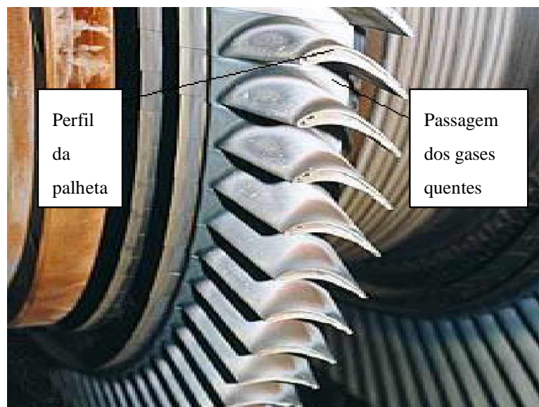
Figura 3 - Rotor de turbina a gás e suas palhetas ( http://www.vtt.fi/tuo/projects/gt_escs.htm-5k_ ).
