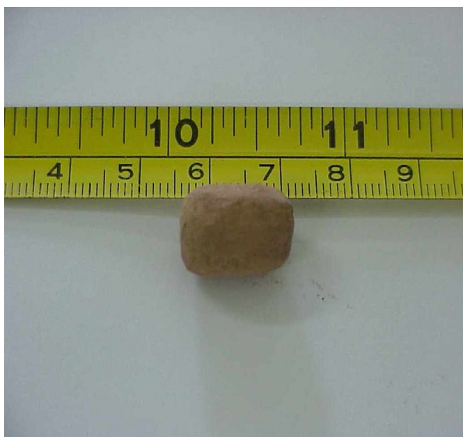
Figura 18 - Corpo de prova com depósito de cinzas de celulignina.
