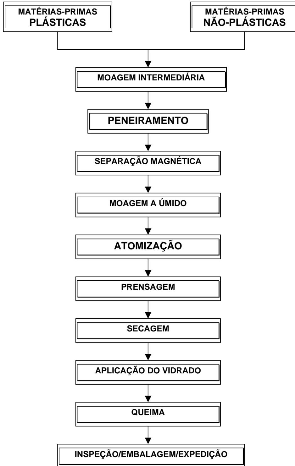
Figura 2.3 – Fluxograma para a Fabricação de Porcelanas.
