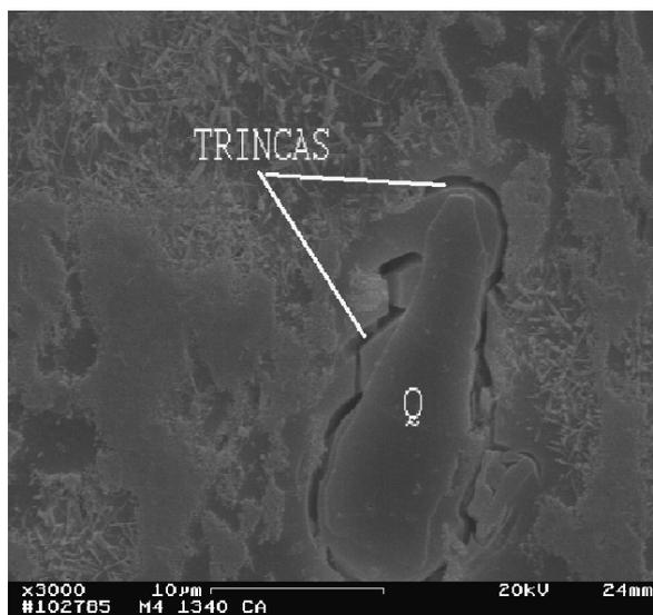
**Figura 4.33 — Fotografia (massa M4 sinterizada em 1340°C) mostrando trincas ao redor dos grãos de quartzo; (3000x).**
