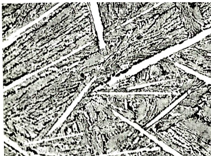
Figura 4 – Micrografia de um ferro fundido branco hipereutético com estrutura de longos cristais de Fe 3 C sobre uma matriz de ledeburita no aumento 150x (Chiaverini, 2012).
