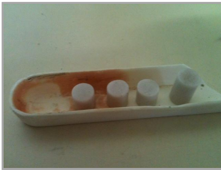
Figura 15. Amostras de Feldspato K sinterizadas, sobre suporte de alumina.
