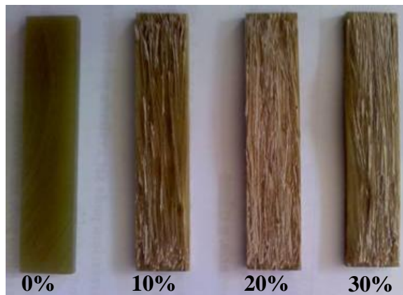
Figura 24 – Espécimes DMA de compósitos de matriz poliéster incorporada com fração de volume diferentes de fibra de bananeira (Rosa et al , 2011).
