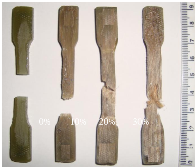
Figura 34 - Corpos de prova após o ensaio de tração para cada fração volumétrica de fibra de juta incorporada à matriz poliéster.
