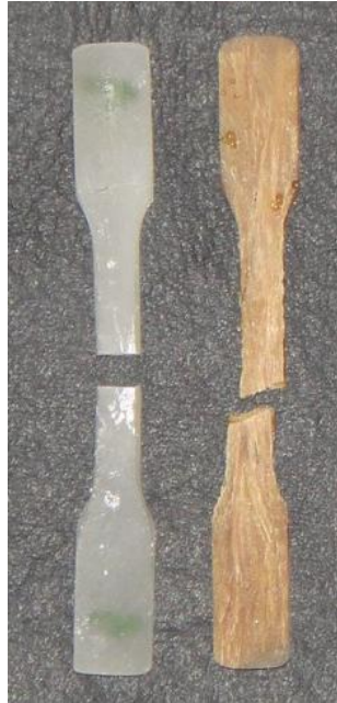
Figura 21 – Corpos de prova de fibra de juta em resina epóxi (Silva, 2012).
