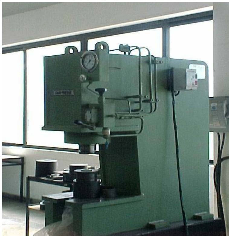
Figura 3.5 – Prensa hidráulica, usada na etapa de compactação, DAN PRESSE – capacidade 20 toneladas.
