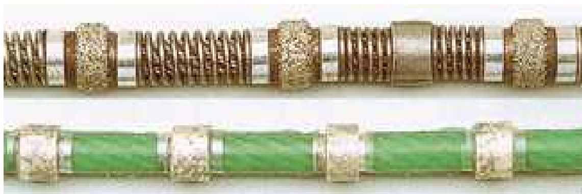
Figura 2.2 – Fios diamantados com sistemas de espaçamento por molas (mármore) e por plástico moldado por injeção (granito) [Filgueira, 2000].
