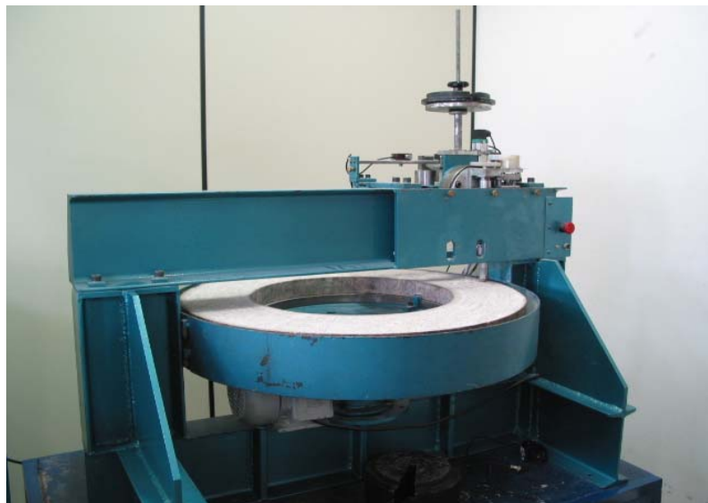
Figura 3.7 – Abrasímetro especial modificado microprocessado.
