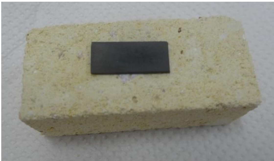
Figura 41 - Fotografia do substrato lixado de aço inoxidável AISI 444 revestido com o filme depositado a 280 °C, a partir da solução precursora 2, e tratado termicamente a 900°C por 6 horas.
