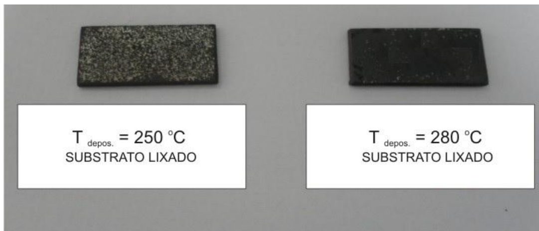
Figura 35 – Fotografia dos filmes depositados a 250 °C e a 280 °C em substratos lixados, obtidos após tratamento térmico a 900 °C por 6h em atmosfera ambiente.
