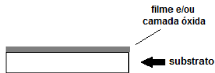
Figura 25 - Exemplo de amostra a ser submetida ao método de medida quatro pontas para determinação de sua resistividade.
