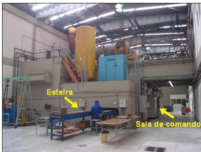
Figura 3.5 – Dynamitron Radiation Dynamics (Acelerador industrial de elétrons) USP/São Paulo.
