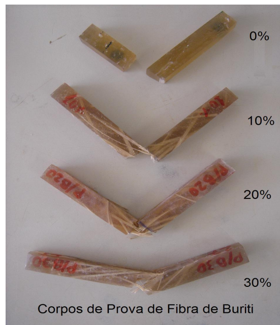
Figura 4.42 Aspectos macroestruturais da ruptura por impacto Charpy de compósitos de matriz poliéster com diferentes frações volumétricas de fibras de buriti.
