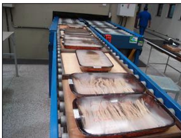
Figura 3.6 – Bandejas onde as fibras foram colocadas e percorreram um caminho durante a irradiação USP/São Paulo.
