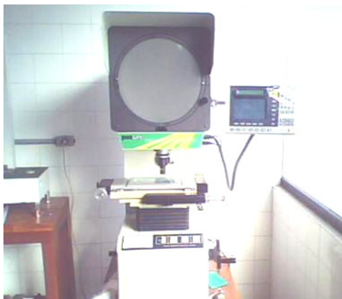
Figura 3.2 – Projetor de perfil Nikon, utilizado para medir os diâmetros das fibras de Buriti LAMAV/UENF.
