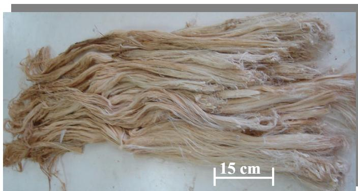
Figura 3.2: Fibras longas de curauá como comercializadas. Adaptado de Monteiro et al (2006).
