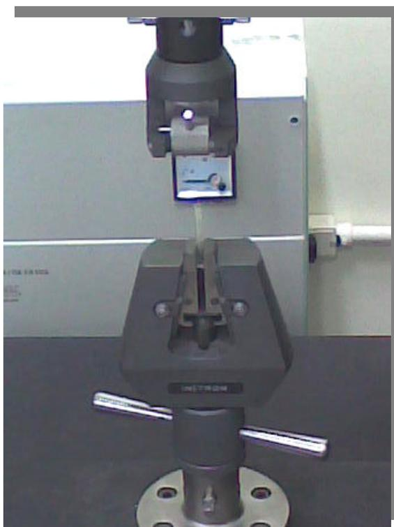
Figura 4.11: Ensaio de pullout.
