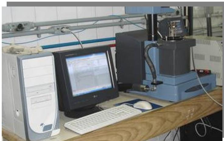
Figura 3.14: Equipamento de DMA TA Instruments, modelo Q800.
