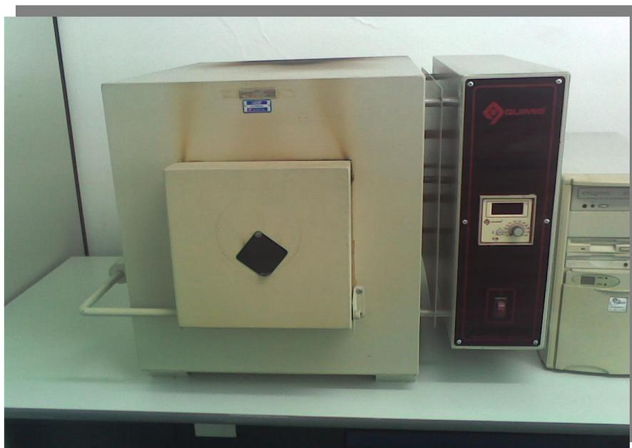
Figura 3.8: Forno Mufa Usado para incineração das fibras.
