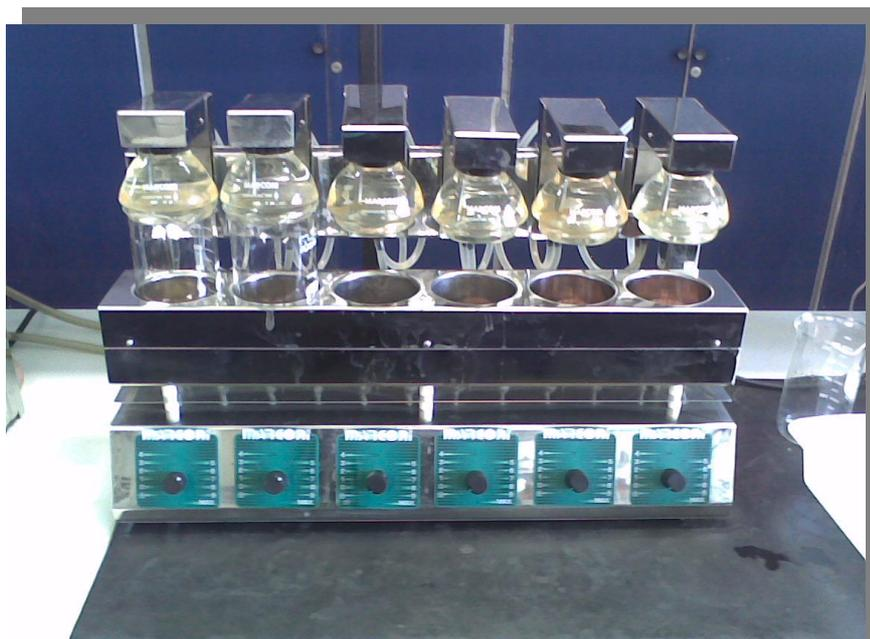
Figura 3.7: Aparelho digestor de fibra - MA 450.
