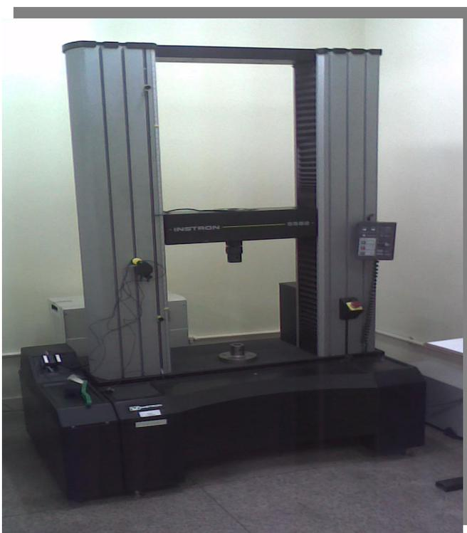
Figura 3.12: Máquina Instron modelo 5582.
