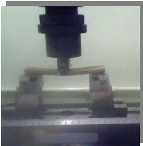
Figura 4.15: Ensaio de Flexão de 3 pontos com corpo de prova de curauá.
