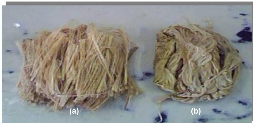
Figura 3.4: Mechas de fibra de Curauá: (a) sem tratamento (b) com tratamento NaOH 10% por 1 hora.
