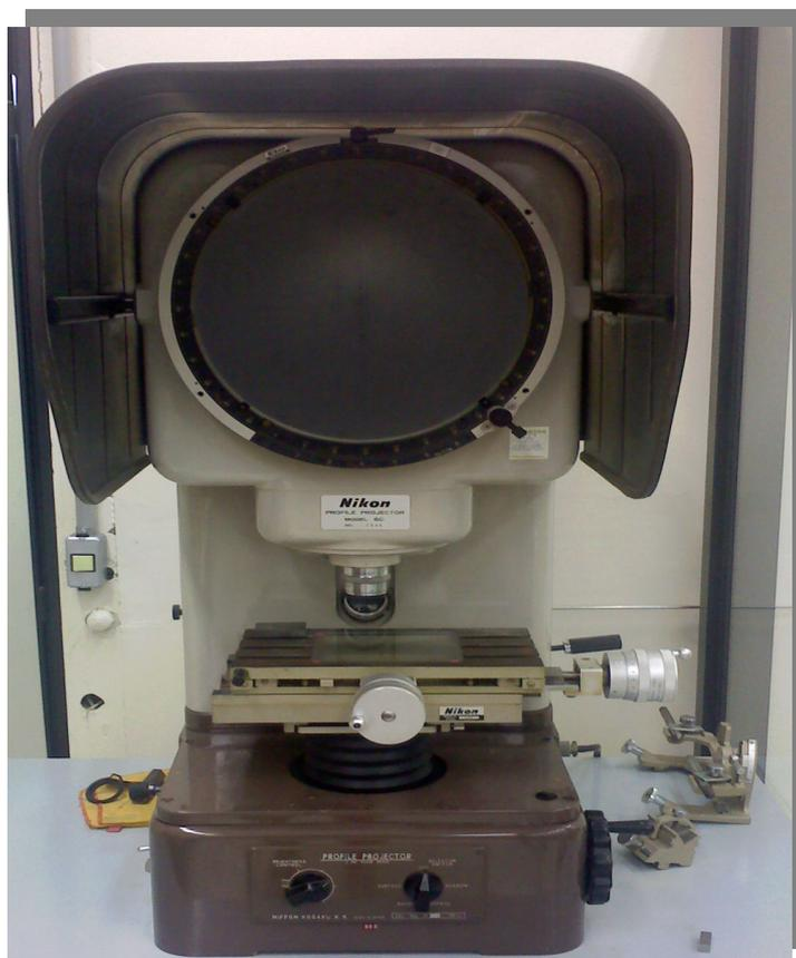
Figura 3.3: Projetor de perfil Nikon, utilizado para medir os diâmetros das fibras de curauá.
