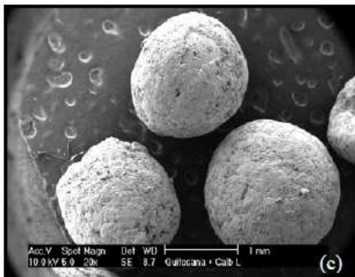
**Figura 15** - Esferas de quitosana immobilizadas com CALB L com glutaraldeído 3%.
