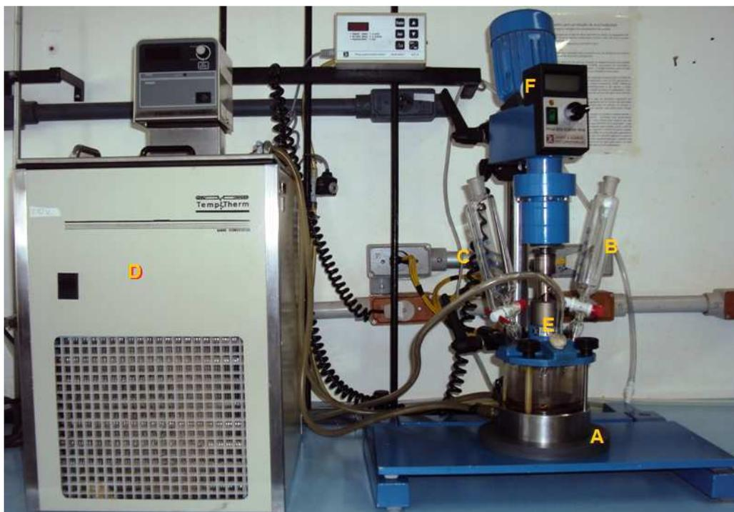
**Figura 37** – Reator IKA-250 existente no setor de polímeros do LAMAV.
