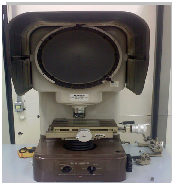
Figura 23 - Projetor de perfil Nikon, utilizado para medir os diâmetros das fibras de rami (Adaptado de MONTEIRO ET AL, 2008)
