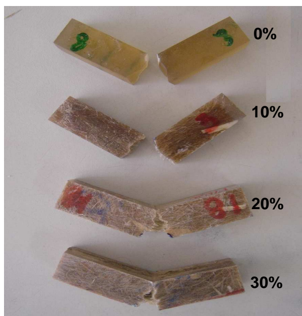
Figura 53 – Aspectos macroestruturais da ruptura por impacto Izod de compósitos de matriz poliéster com diferentes frações volumétricas de fibras de rami (adaptada de MONTEIRO ET AL, 2009).
