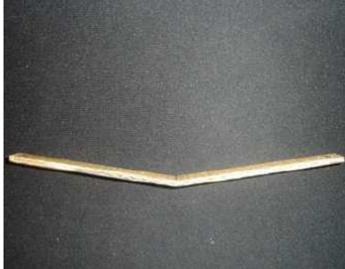
Figura 8 - Corpo de prova após ensaio de Flexão (Adaptado de SABARIZ ET AL 2006).
