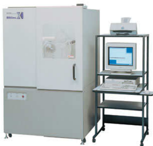
Figura 37 - Difratômetro marca Shimadzu modelo XRD 7000, utilizado para as análises.
