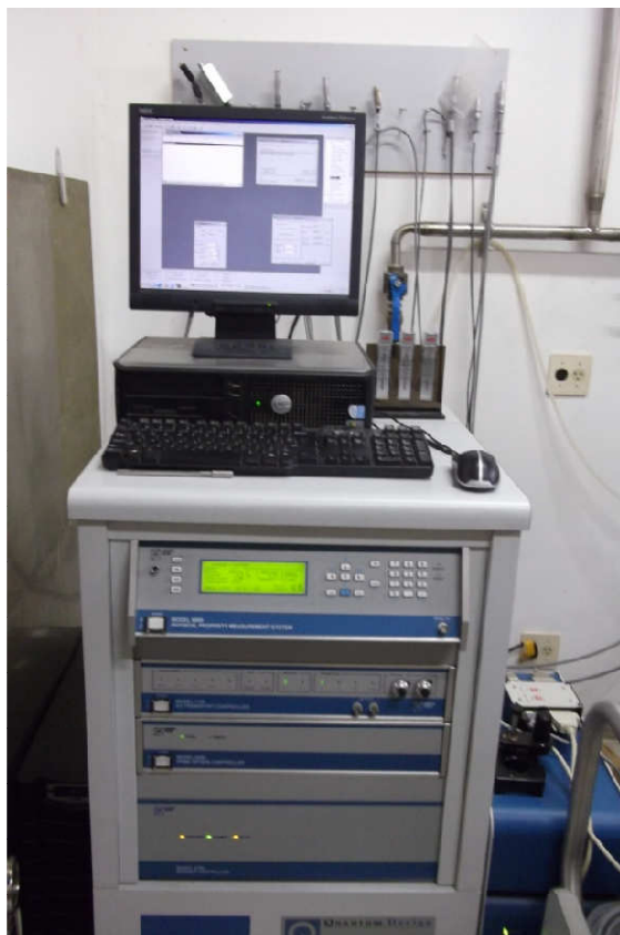
Figura 40 - Magnetômetro de Amostra Vibrante marca OXFORD VSM, Modelo 3001 utilizado para as análises
