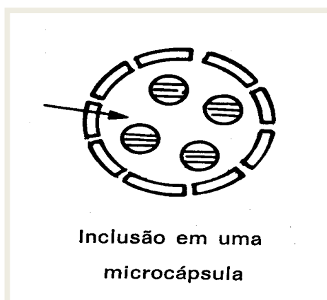
Figura 27 – Imobilização de um biocatalisador via inclusão ou microencapsulamento.
