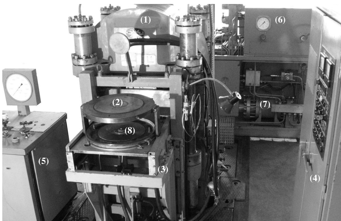
Figura 24 – Prensa hidráulica para a produção de materiais superduros com força de 2500 ton. 1 – Prensa; 2 – DAP; 3 – Mecanismo de carregamento; 4 – Painel de comando local; 5 – Bomba hidráulica auxiliar; 6 – Unidade hidráulica (2 bombas); 7 - Multiplicador de pressão; 8 – Cápsula deformável.
