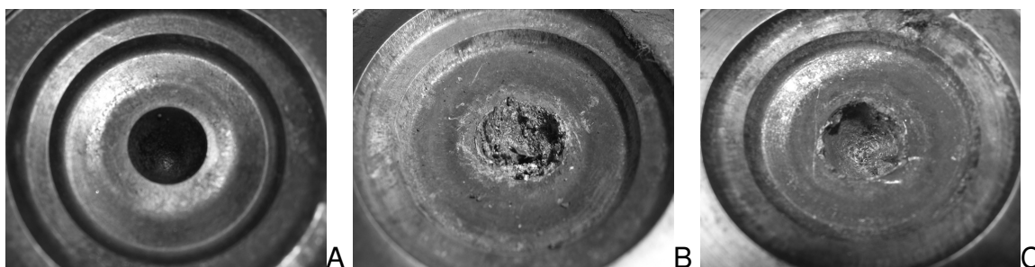
Figura 85 – Eletro erosão das bigorna com (A) e sem (B e C) sistema de detecção.
