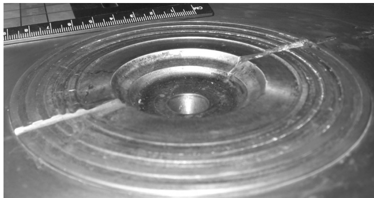
Figura 34 - Imagem da bigorna com canal usinado para calibração de temperatura.
