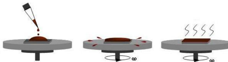
Figura 2.24: Processo de deposição de filmes por spin coating ( http://ssg.epfl.ch/dev-prep.html , 2006).
