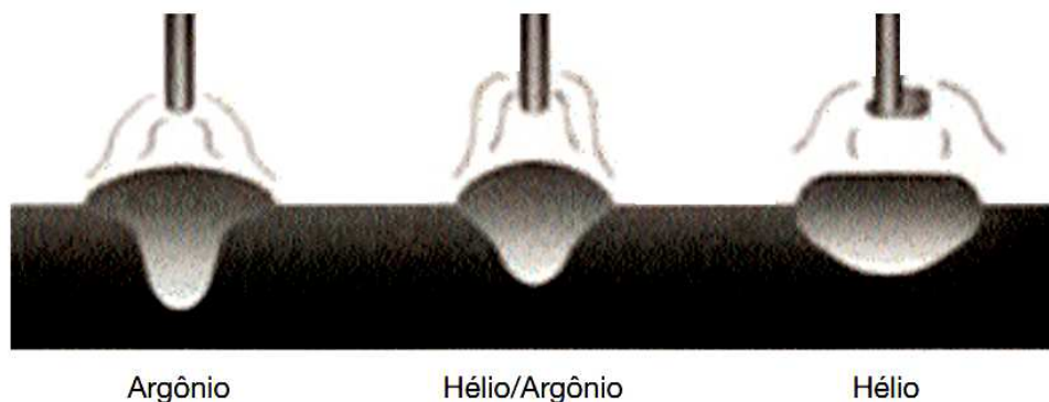
Figura 5 - Perfis de solda GMAW com diferentes atmosferas de proteção (Fortes e Araújo, 2004).
