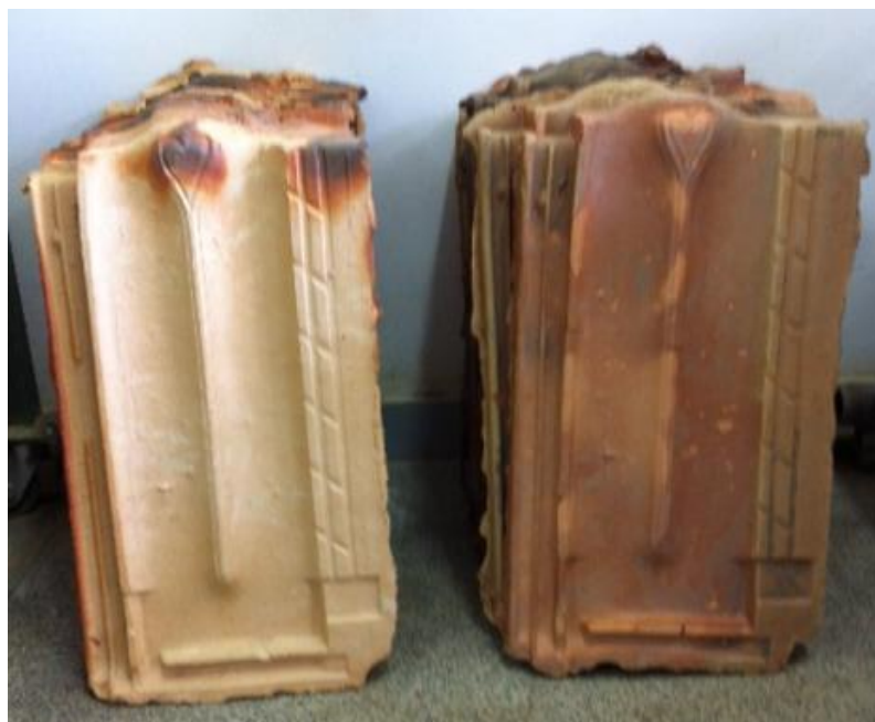
Figura 6.43 – Telhas à esquerda sem RVL e à direita com RVL
