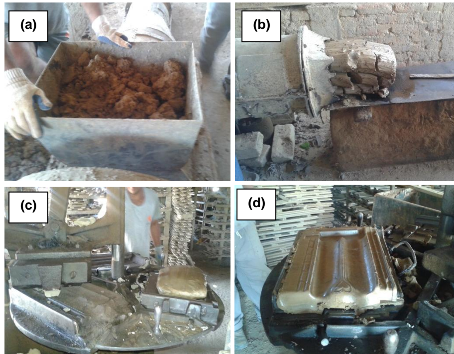
Figura 5.8 – Etapas do processamento das telhas no teste industrial
