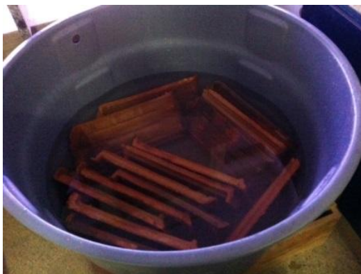
Figura 5.10 – Imersão das telhas no ensaio de Absorção de Água
