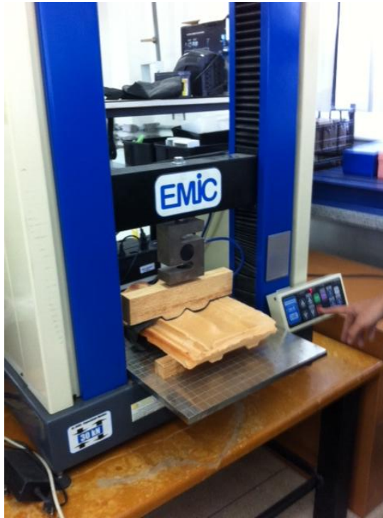
Figura 5.11 – Ensaio para determinação da carga de ruptura
