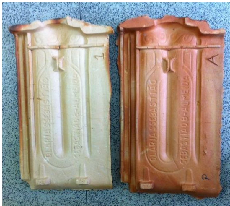
Figura 6.44 – Telhas à esquerda sem RVL e à direita com RVL
