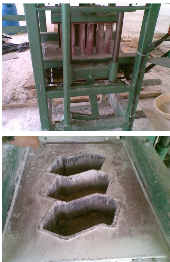
Figura 4.5 – Máquina de vibro-compressão para confecção dos pavimentos de concreto
