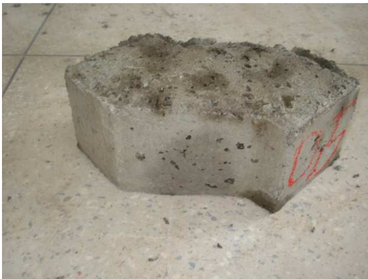
Figura 5.17 – Traço T20 sem porosidade excessiva e consistência adequada
