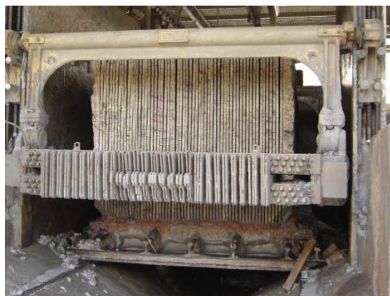
Figura 2.2 – (a) Blocos de Rocha em Estado Bruto; (b) Processo de Serragem no Tear. (a) LBRO na Serragem dos Blocos; (b) Granalha.
