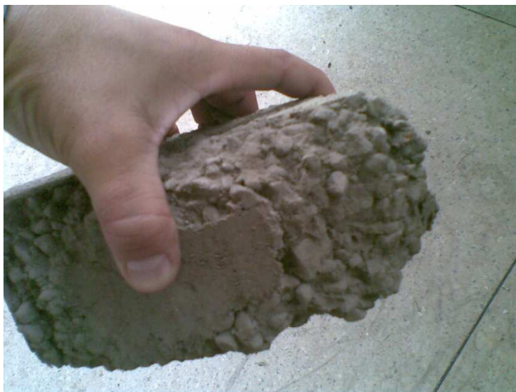
Figura 5.14 – Aspecto geral dos pavimentos com 10% de cimento e 0,5 de a/c demonstrando falta de coesão.
