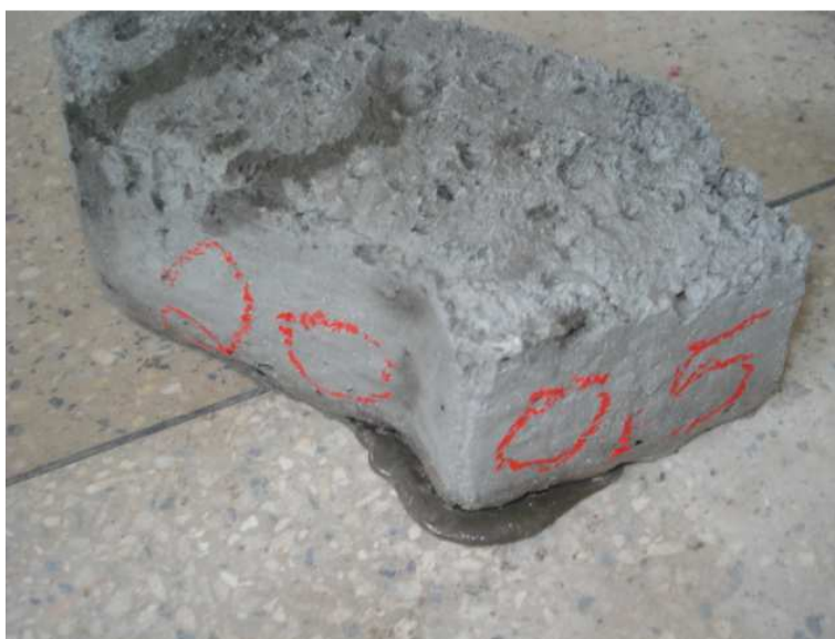
Figura 5.22 – Traço T21 com consistência inadequada e perda de pasta
