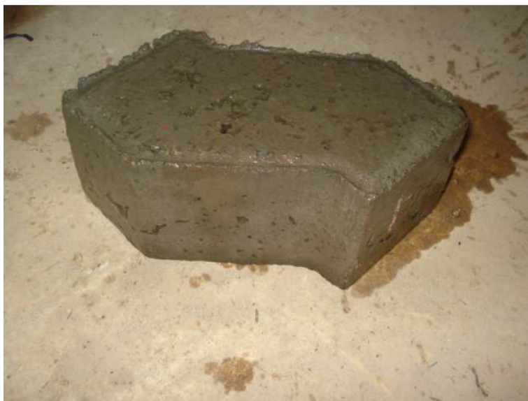
Figura 5.21 – Traço T22 com consistência adequada e sem porosidade excessiva
