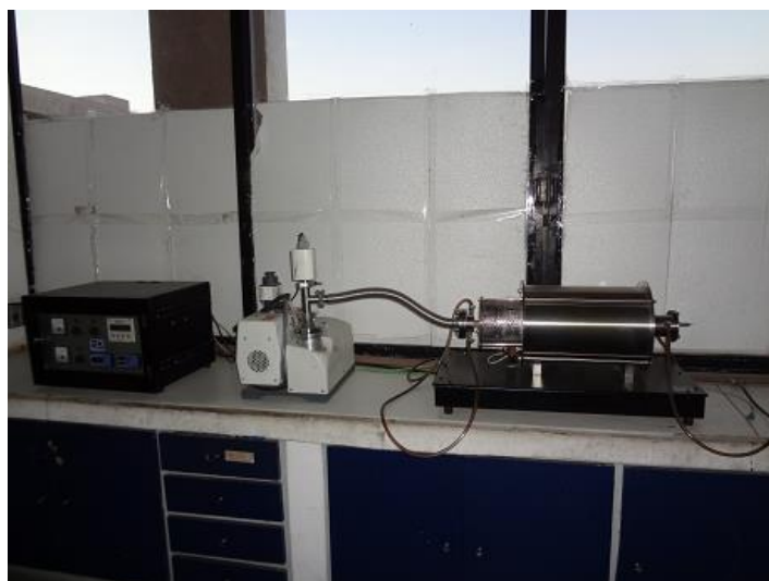
Figura 28. Forno da marca BP engenharia, Tiristorizado, de resistência tubular de SiC, e tubo interno de \text{Al}_2\text{O}_3 acoplado a uma bomba de alto vácuo da marca Adixem Packtel 1025.
