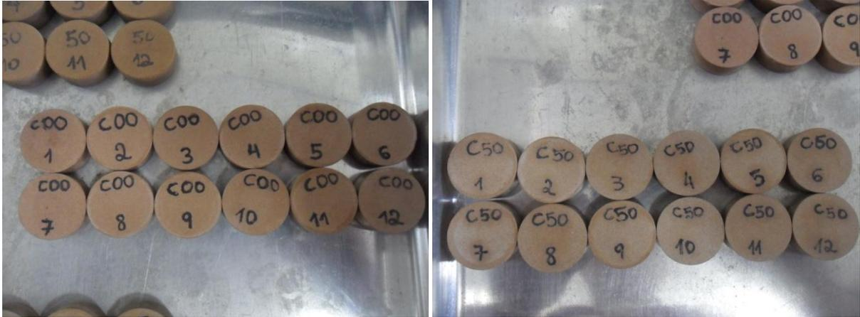
Figura 4.27 – Corpos de prova prensados com os pós de Silicato de Cálcio produzido.
