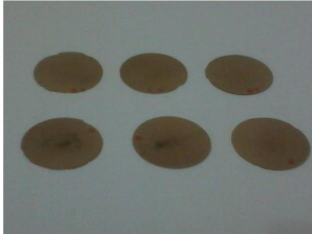
**Figura 3.2 – Corpos-de-prova produzidos para o ensaio de Capacidade Térmica e Difusividade**
