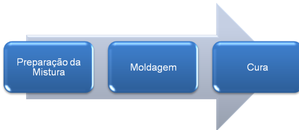
Figura 3.5. Fluxograma do processo de produção dos corpos de prova cilíndricos incorporados com resíduo de CBC seguindo os procedimentos da norma ABNT NBR 12024 (2012) – Solo-cimento – Método A.
