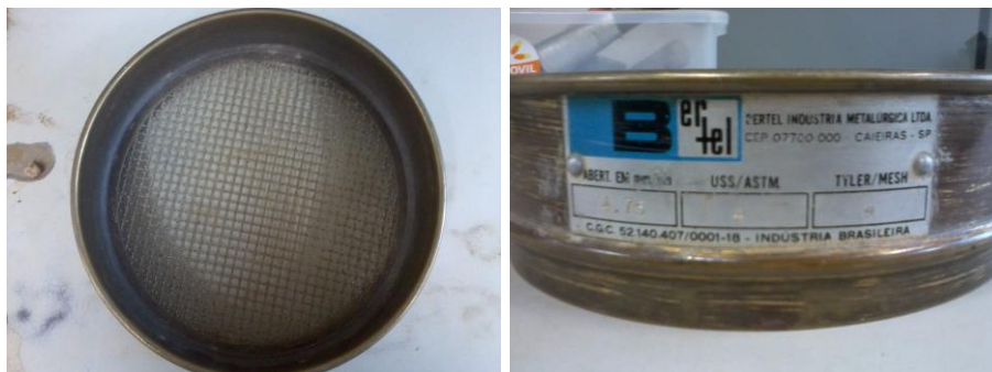
Figura 3.3. Peneira Bertel nº 4 ASTM que foi utilizada para peneiramento.
