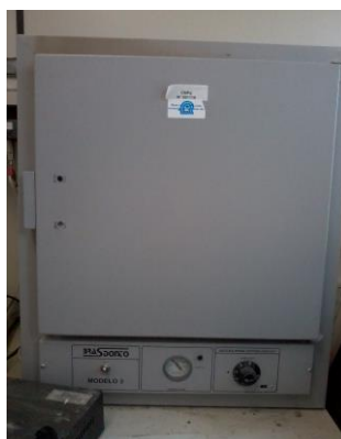
Figura 3.2. Estufa Brasdonto, modelo 3, que foi utilizada para eliminar a umidade residual do solo.
