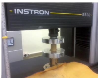
Figura 3.9. Ensaio de resistência à compressão simples realizado em corpos de prova cilíndricos.
