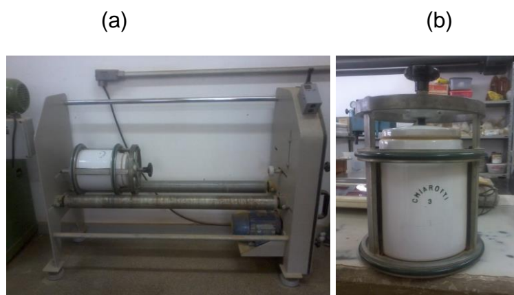
Figura 3.4. a) Moinho de bolas Gardelin, modelo 1A, que foi utilizado para conferir a granulometria desejada ao resíduo de CBC; b) copo do moinho de bolas.
