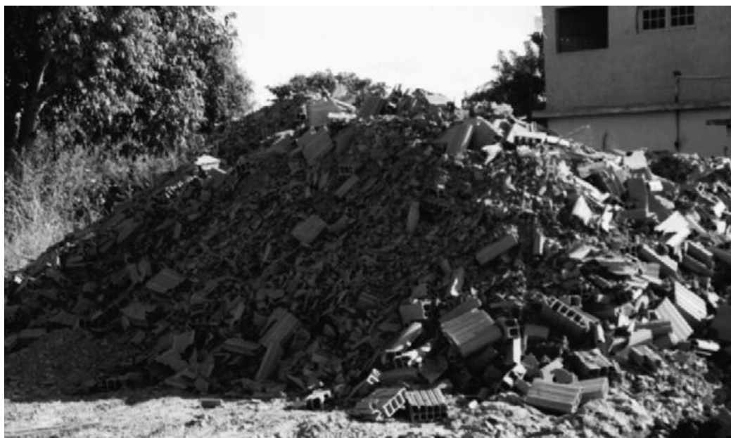
Figura 2.7- Resíduos de tijolos (chamote) gerados por uma indústria de Campos dos Goytacazes, Brasil (Vieira et al., 2007).
