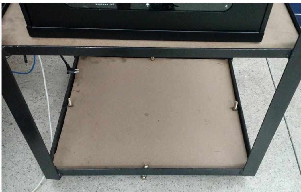
Figura 3.18 – Base da estrutura metálica da máquina.
