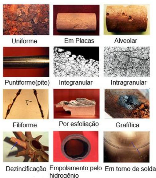
Figura 2.1 – Classificação da corrosão quanto a sua morfologia (Ponte, 2003).
