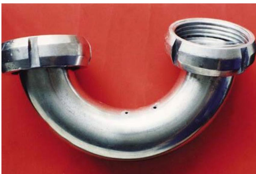
Figura 2.2 – Corrosão por pites em aço inoxidável. (Ponte, 2003)
