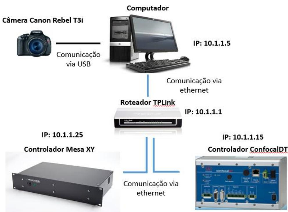
Figura 3.19 – Esquema de comunicação entre os dispositivos da máquina.
