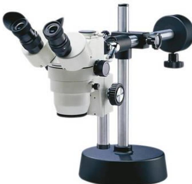
Figura 3.8 – Microscópio estereoscópio (National Optical, 2015).
