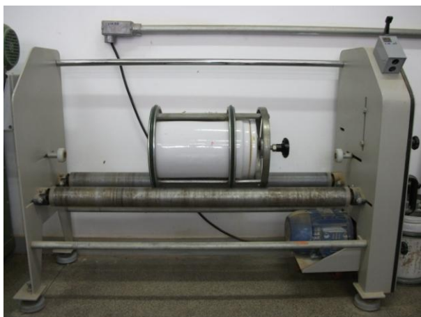
Figura 5.3: Moinho de porcelana lisa e bolas utilizado para a homogeneização das massas.
