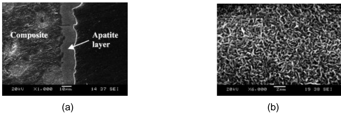
Figura 7 – Fotografia de microscopia eletrônica de varredura (a) mostram a camada de apatita e (b) sua microestrutura (Ni e Wang, 2002).
