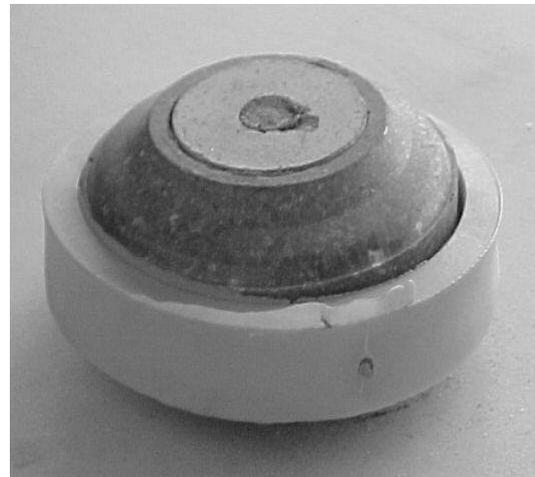
Figura 25 - Cápsula montada com anel de PVC.
