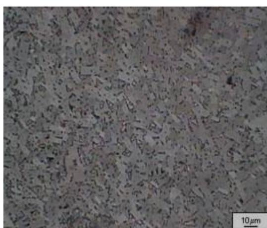
Figura 52 - Micrografia da amostra D17 (5GPa/1500°C/4min) - 500X.
