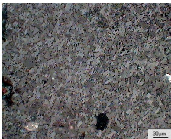
Figura 49 - Micrografia da amostra P11 (5GPa/1400°C/4min) - 250X.
