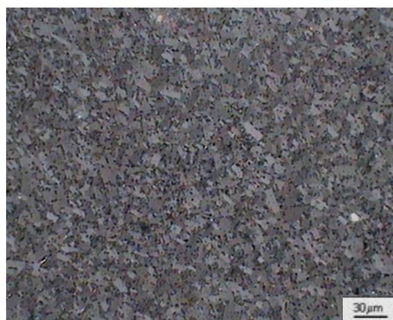
Figura 50 - Micrografia da amostra D11 (5GPa/1400°C/4min) - 250X.
