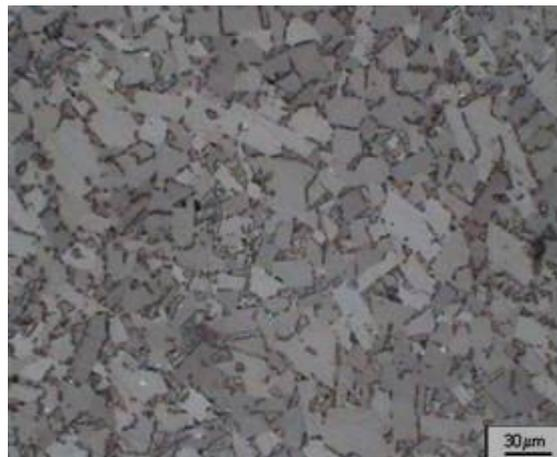
Figura 42 - Micrografia da amostra convencional dopada C2 - 250X.
