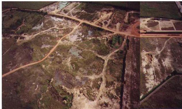
**Figura 2.5 – Vista aérea de exploração. Nota-se a interrupção da exploração ao se atingir o lençol freático (Ramos, 2000).**
