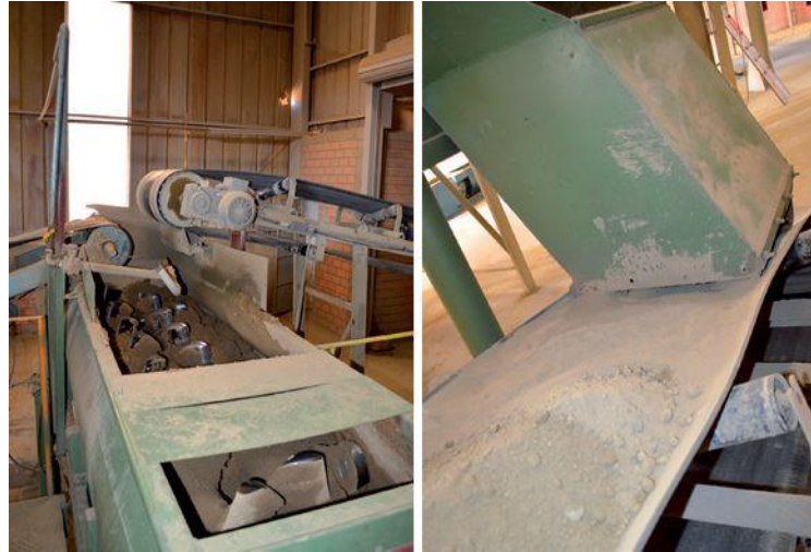
Figura 5 – Processo de Desintegração Fonte: Equipedeobra, 2012.
