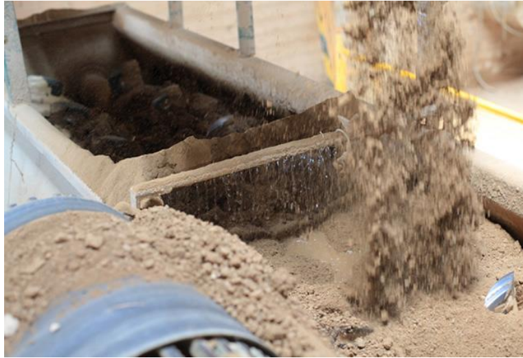
Figura 6 – Processo de preparação da massa cerâmica Fonte: Fernandes Terra, 2009.
