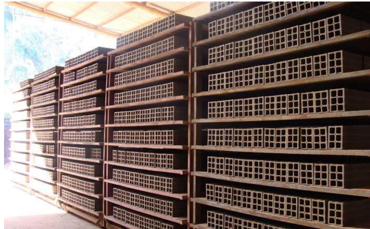
Figura 8 – Processo de secagem Fonte: Belavistatijolos, 2014.
