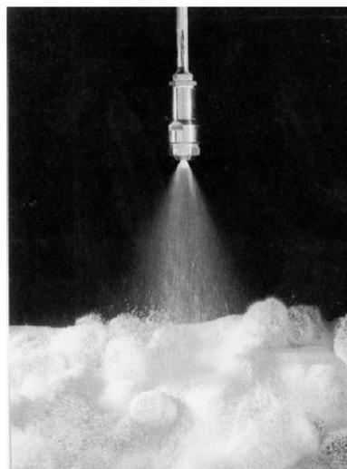
Figura 2.6: *Spray* de líquido ligante incidindo sobre uma camada de pó fluidizado (Pietsch, 2002).
