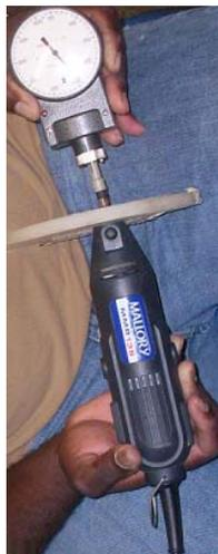
Figura 4.18: Medição de velocidade da micro retífica pelo tacômetro.
