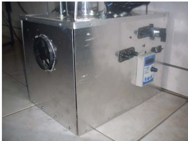
Figura 4.2: Fuselagem, de aço inox do equipamento, mostrando dispositivos de comando e ventilador fixados a ela.
