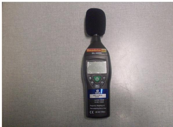
Figura 3.4: Decibelímetro DL 4020 usado para medição de ruído.
