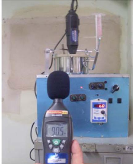
Figura 4.19: Momento da medição de nível de ruído produzido pela máquina.
