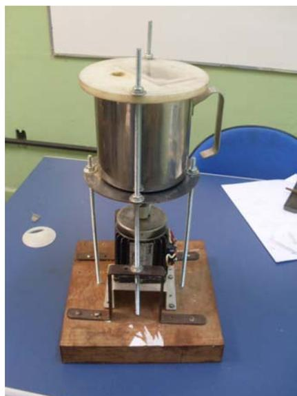
Figura 4.1- Base de madeira ao qual são fixados a haste em U, as varas rosqueadas, o disco metálico e a fuselagem da máquina.
