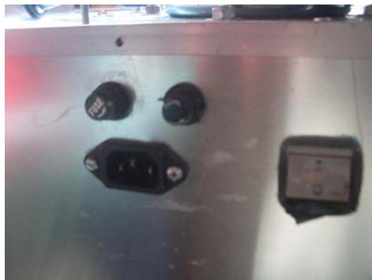
Figura 4.12: Plugue fêmea de alimentação da máquina aglomeradora com três pinos, fusíveis de proteção e chave geral liga/desliga.
