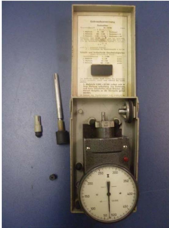
Figura 3.3: tacômetro analógico usado para determinação de escalas de velocidade de rotação da hélice impelidora e da lâmina cortadora.
