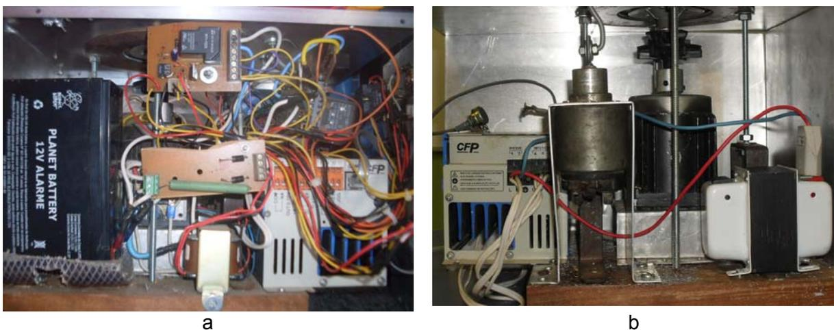
Figura 4.13: Bateria 12V, seu circuito carregador e transformador que alimenta este circuito (a). Transformador que alimenta as cargas de 127V à direita (b)
