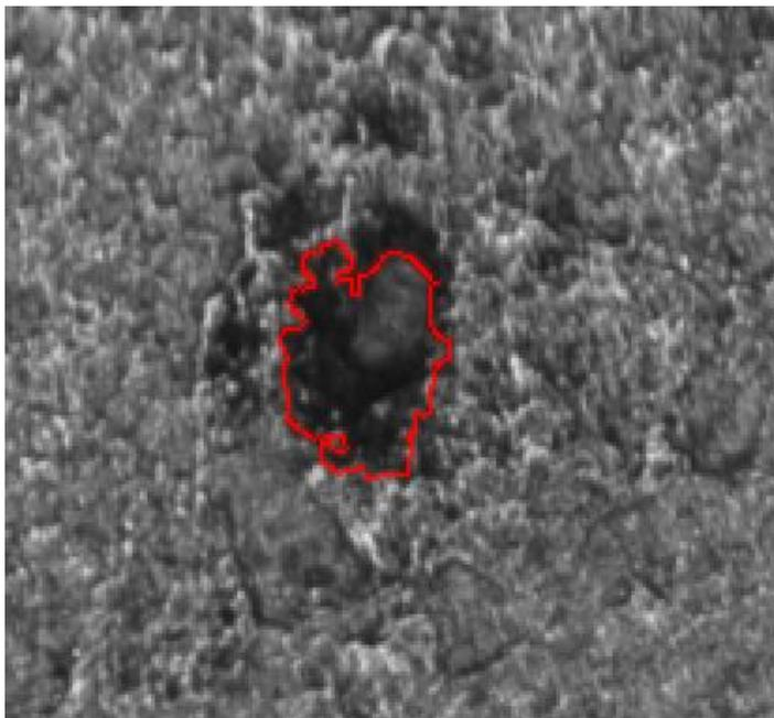
Figura 4.27 - Sobreposição de contorno do pite segmentado na imagem original.
