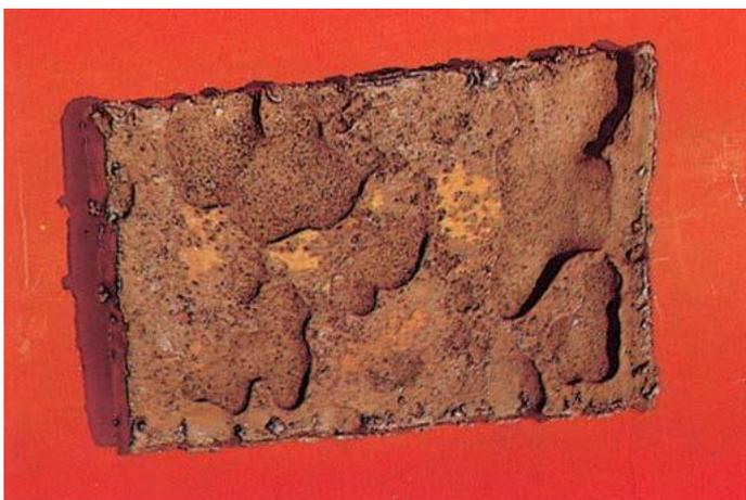
Figura 2.2 - Trecho de chapa com corrosão em placas (Gentil, 2003 apud Arruda, 2009).
