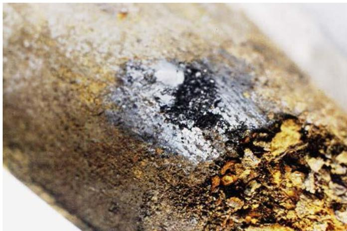
Figura 2.11 - Corrosão gráfitica em tubo de ferro fundido cinzento (Gentil, 2003 apud Arruda, 2009).
