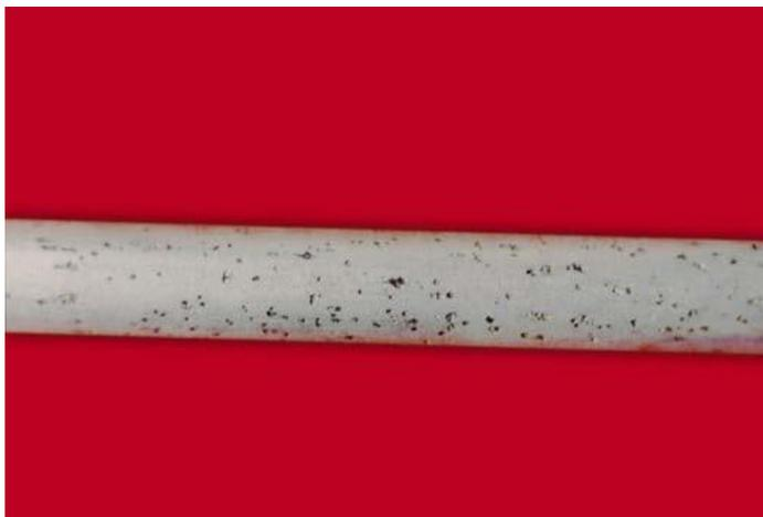
Figura 2.5 - Tubo de aço inoxidável AISI 304 com corrosão por pite (Gentil, 2003 apud Arruda, 2009).
