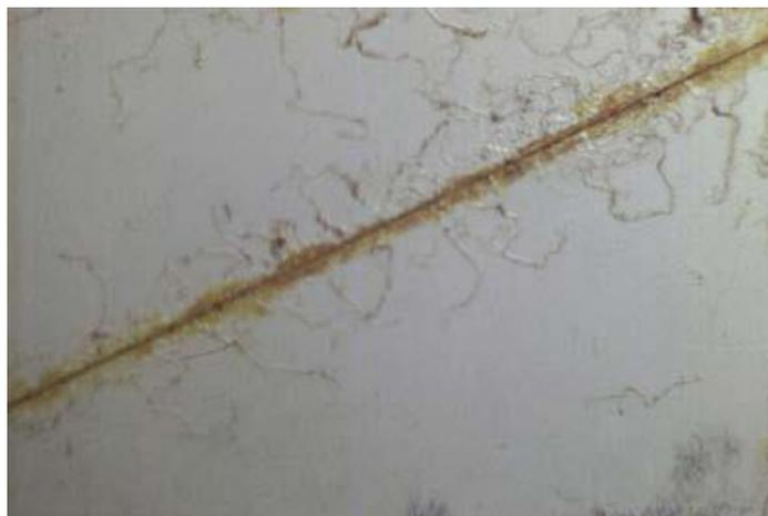
Figura 2.8 - Corrosão filiforme em superfície com película de tinta (Gentil, 2003 apud Arruda, 2009).
