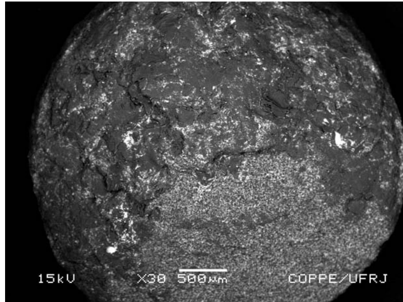
Figura 53 – Amostra 15Ab (granulometria do diamante = 40/28 \mu\text{m} , arranjo tipo b , P = 7,7 GPa, T = 1800^\circ\text{C} , t = 30\text{s} ) amostra não retificada.
