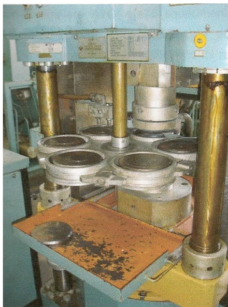
Figura 25 – Prensa de 630 ton detalhe do conjunto de dispositivos e cápsula deformável.
