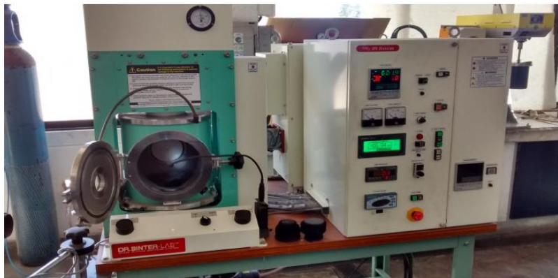
Figura 43 - Equipamento de Sinterização por Plasma Pulsado - Setor de Materiais de Alta Dureza LAMAV – UENF).
