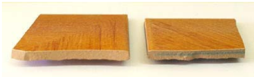
Figura 21: Peças cerâmicas, à esquerda sem e à direita com coração negro.
