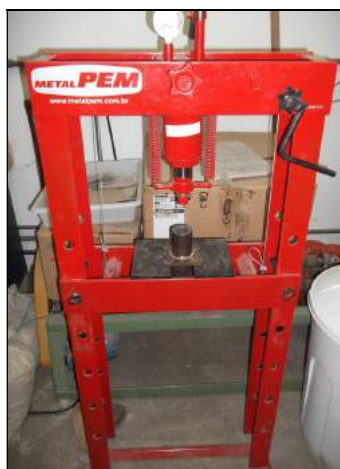
Figura 3.2 – Prensa hidráulica para fabricação de corpo de prova.
