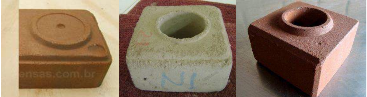
Figura 2.10 – Meio Tijolo de solo-cimento com encaixe.
