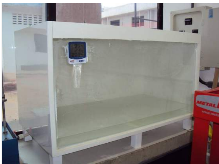
Figura 3.4 – Câmara úmida para processo de cura (Rodrigues, 2012).
