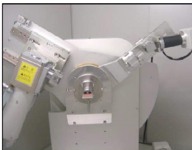
Figura 3.6 – Difratômetro de raios X modelo XRD7000, marca SHIMADZU (Gomes, 2016).
