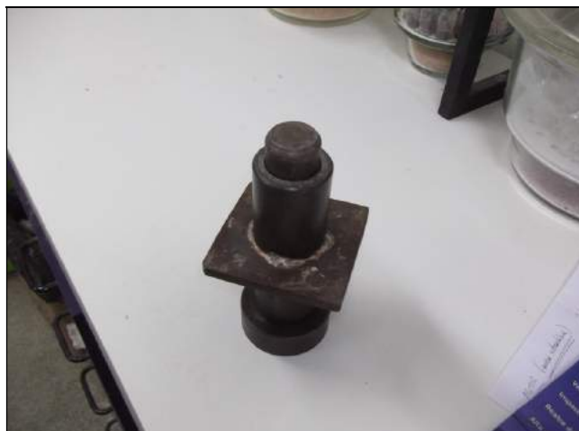
Figura 3.3 - Matriz cilíndrica para fabricação de corpo de prova. (Rodrigues, 2012).
