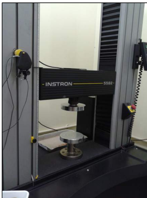
Figura 3.5 – Máquina utilizada no ensaio de compressão simples.
