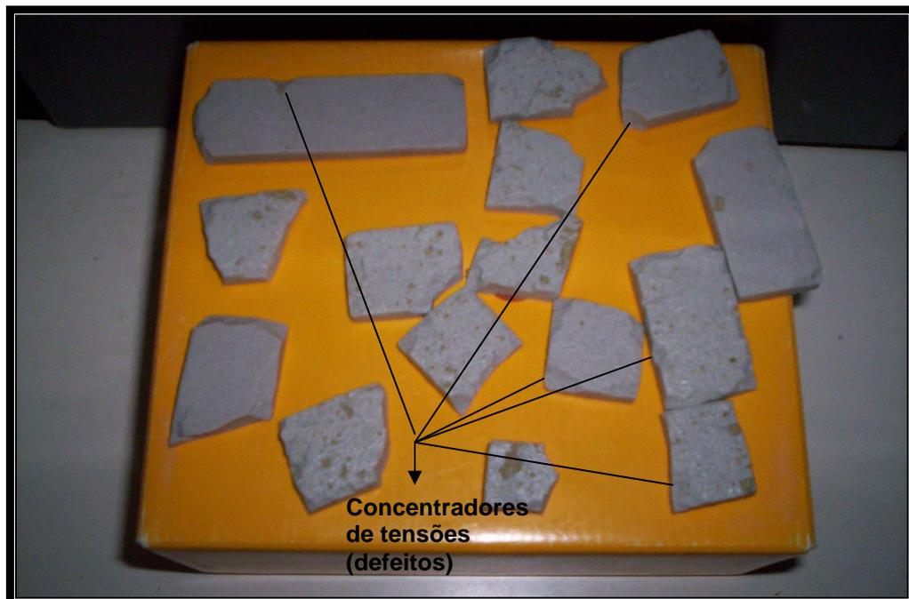
**Figura 4.54 – Pontos concentradores de tensões (massa cerâmica MBIV).**
