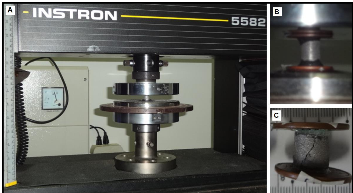
Figura 46 – Ensaio de Compressão (A) máquina do ensaio (B) amostra durante o ensaio (C) amostra após o ensaio.
