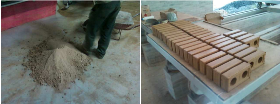
Figura 33: massa sendo preparada e blocos moldados na prensa automática
