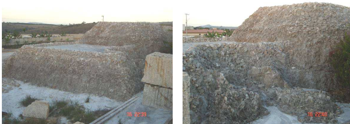
Figura 8: Depósito da lama proveniente da serragem dos blocos de granito (XAVIER, 2006)
