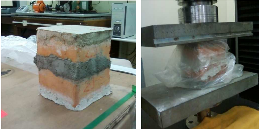
Figura 64:Ensaio do bloco cerâmico
