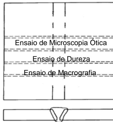
Figura 3.10: Localização dos corpos de prova na chapa de teste para os ensaios de microscopia ótica, dureza e macrografia.
