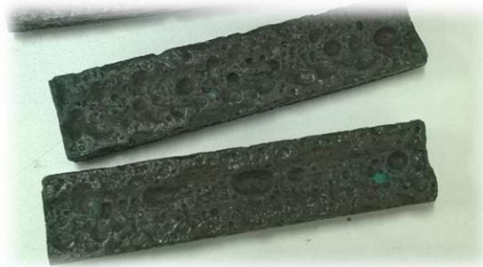
Figura 4.2: protótipos com resquícios do material do molde de silicone.
