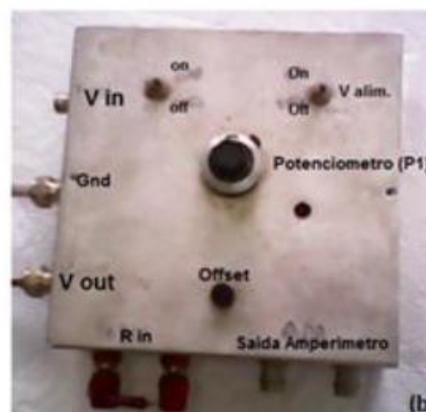
Figura 3-6 - Circuito eletrônico da caixa de medida (a) que contém o amplificador operacional em configuração inversora e (b) caixa com sistema montado disponível no LAMAV/UENF (SANCHEZ, 2014).
