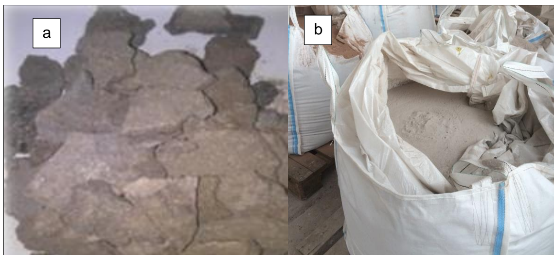
Figura 5.2: Matérias-primas utilizadas. Em “a” a massa argilosa e em “b” o resíduo.
