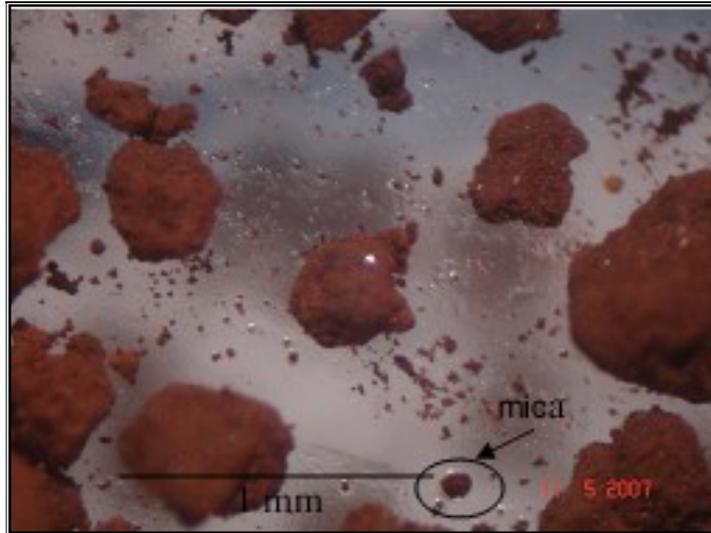
Figura 4.21- Micrografia ótica do resíduo de minério de ferro na forma de pó (Souza, 2007).
