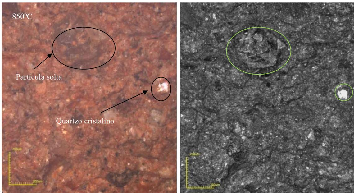
Figura 6.30- Região de fratura da cerâmica com 2,5% de resíduo (escala 200 µm).
