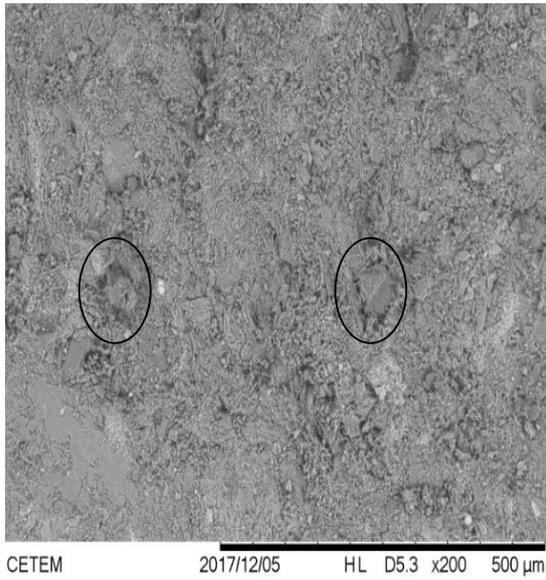
Figura 6.37- MEV da superfície de fratura da cerâmica 0%R e 950°C (200x).
