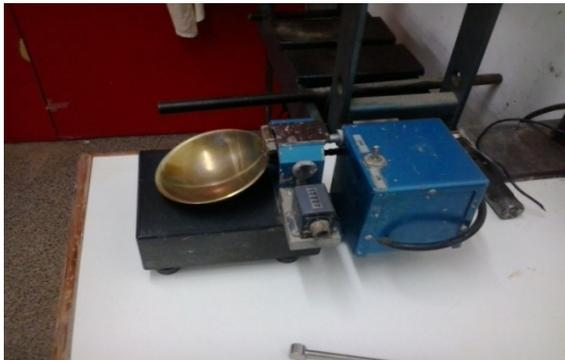
Figura 5.3- Aparelho de Casagrande.
