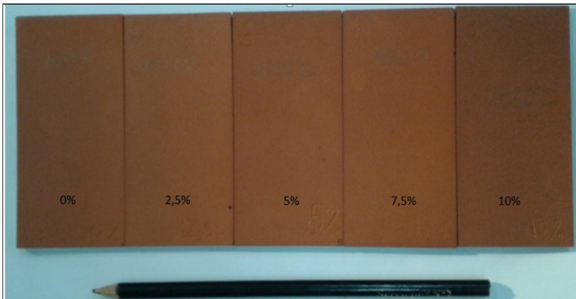
Figura 6.19- Corpos de prova das formulações **M0%R**, **M2,5%R**, **M5%R**, **M7,5%R** e **M10%R** queimados a 1050°C.
