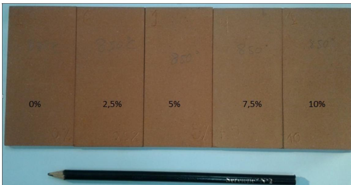
Figura 6.17- Corpos de prova das formulações **M0%R**, **M2,5%R**, **M5%R**, **M7,5%R** e **M10%R** queimados a 850°C.
