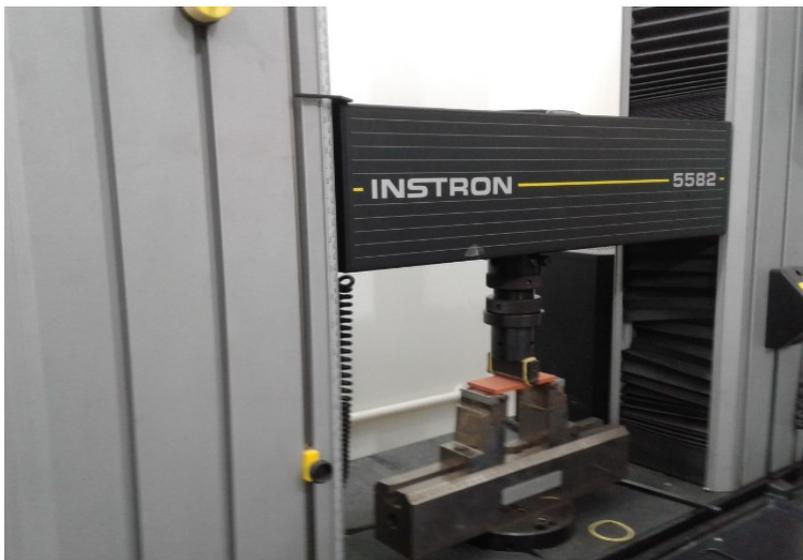
Figura 5.4- Ensaio de tensão de ruptura à flexão.
