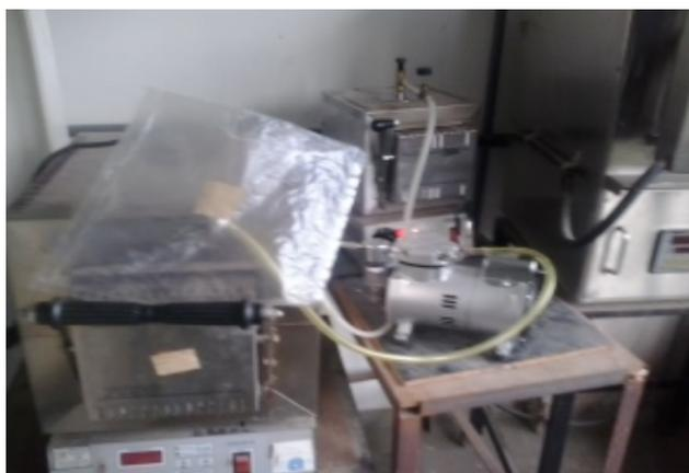
Figura 5.10- Procedimento prático da coleta dos gases de queima das peças cerâmicas.
