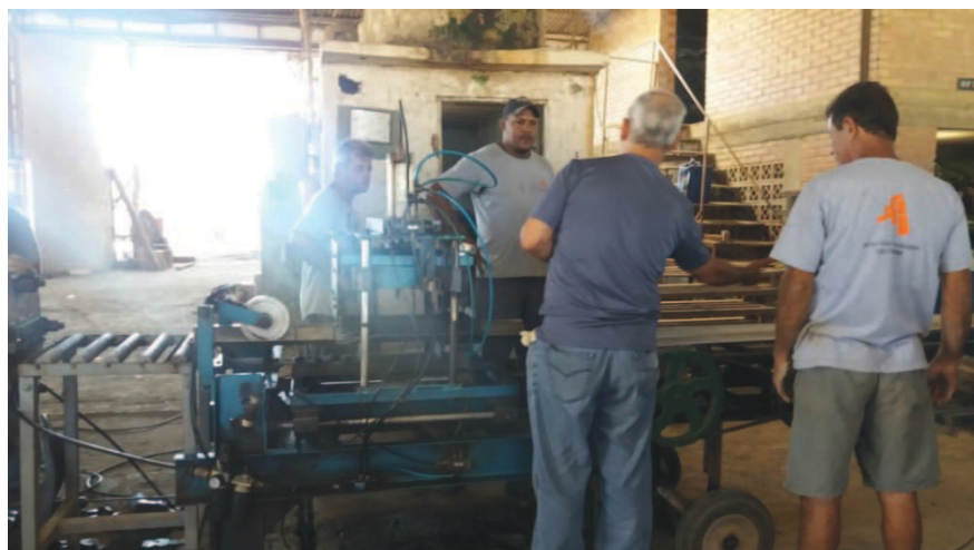
Figura 4.23: Extrusora sendo utilizada na produção das telhas. Fonte: Arquivo pessoal.
