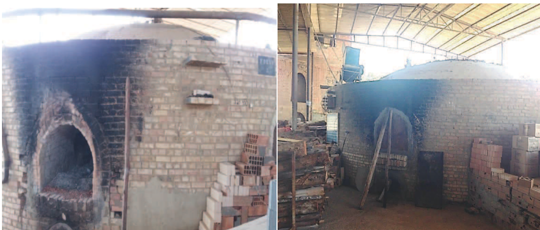
Figura 4.26: Forno tipo abóbada utilizado para a queima das peças produzidas. Fonte: Arquivo pessoal.
