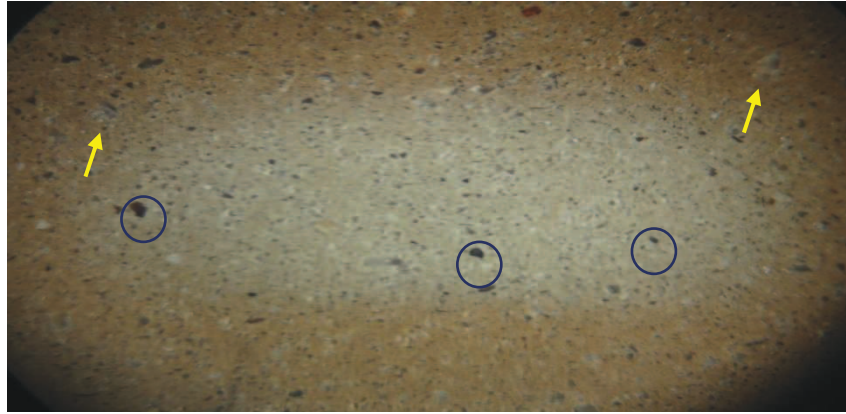
Figura 5.20: Micrografias óticas do corpo de prova da massa cerâmica MRRO, queimados a 850°C e com o aumento de 20x.
