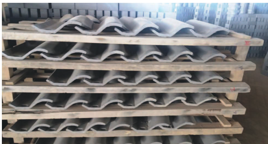
Figura 4.24: Telhas arrumadas verticalmente nos pallets de madeira para o processo de secagem Fonte: Arquivo pessoal.
