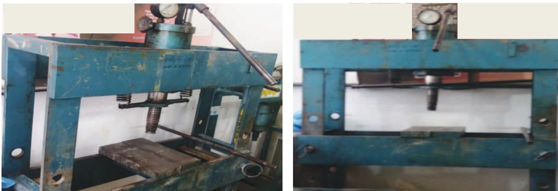
Figura 4.8: Prensa utilizada para a produção dos corpos de prova para o ensaio de dilatométrica.
