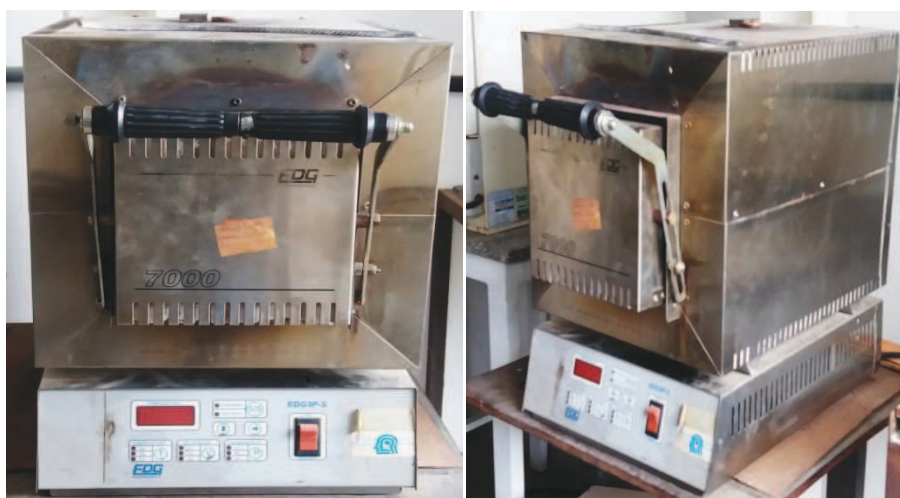
Figura 4.15: Forno laboratorial usado para a queima dos corpos de prova. Fonte: Arquivo pessoal.
