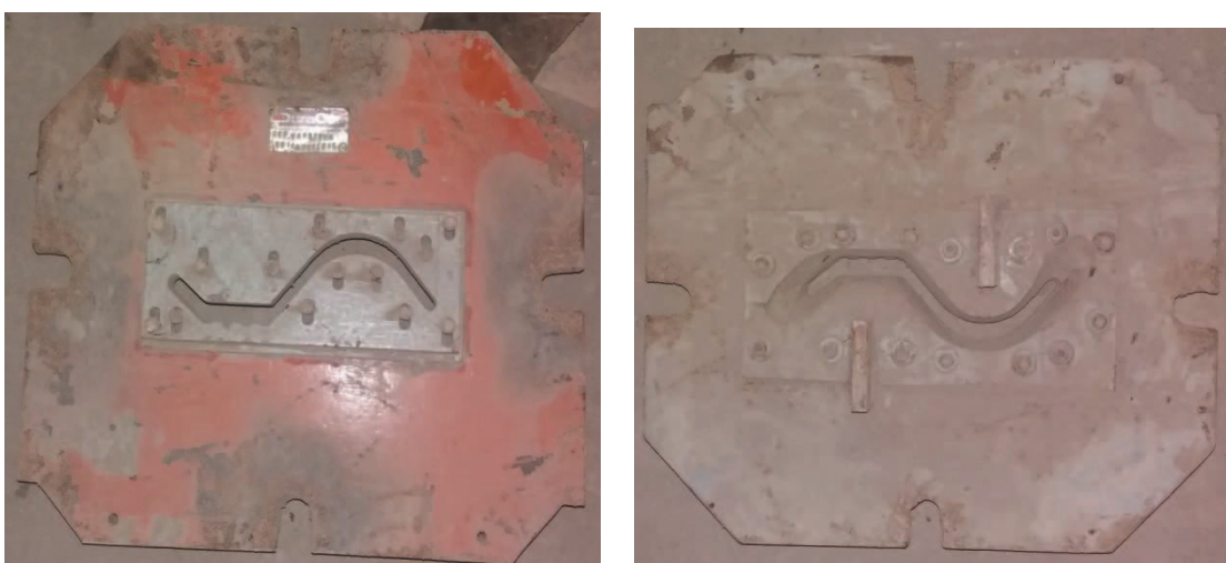
Figura 4.21: Boquilha com o formato da telha portuguesa.
