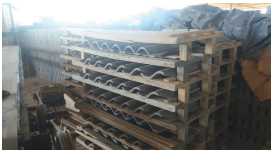
Figura 4.25: Telhas após a retirada da lona plástica. Fonte: Arquivo pessoal.
