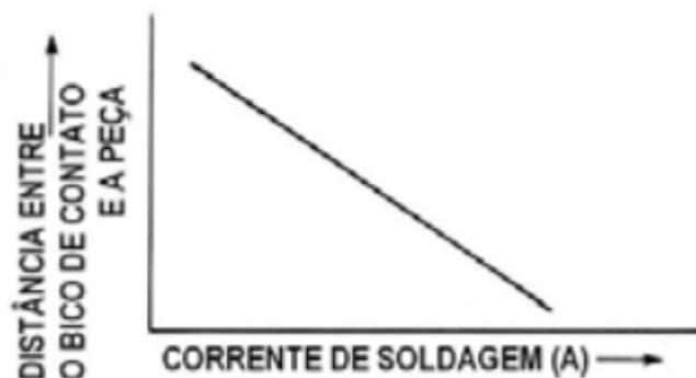
Figura 8: Efeito da distância entre o bico de contato e a peça na corrente de soldagem (adaptado de ESAB, 2005)
