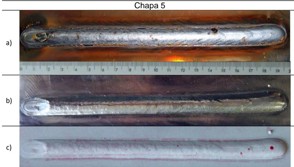
Figura 53: Chapa 5: Ar+12%CO<sub>2</sub>+0,4%C<sub>3</sub>H<sub>6</sub>. a) Antes da limpeza, b) após a limpeza e c) durante o ensaio com líquido penetrante.
