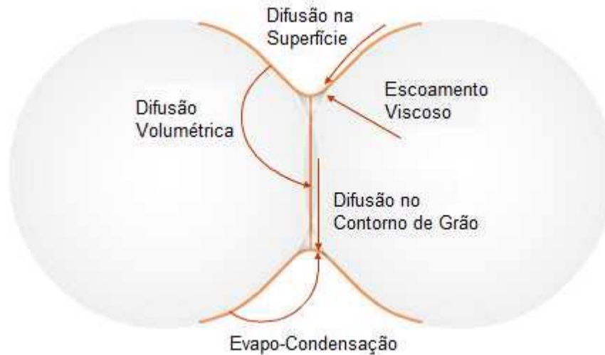
Figura 9. Exemplos esquemáticos de transferência de matéria para sinterização por fase sólida (Adaptado de Hlavác, 1983).
