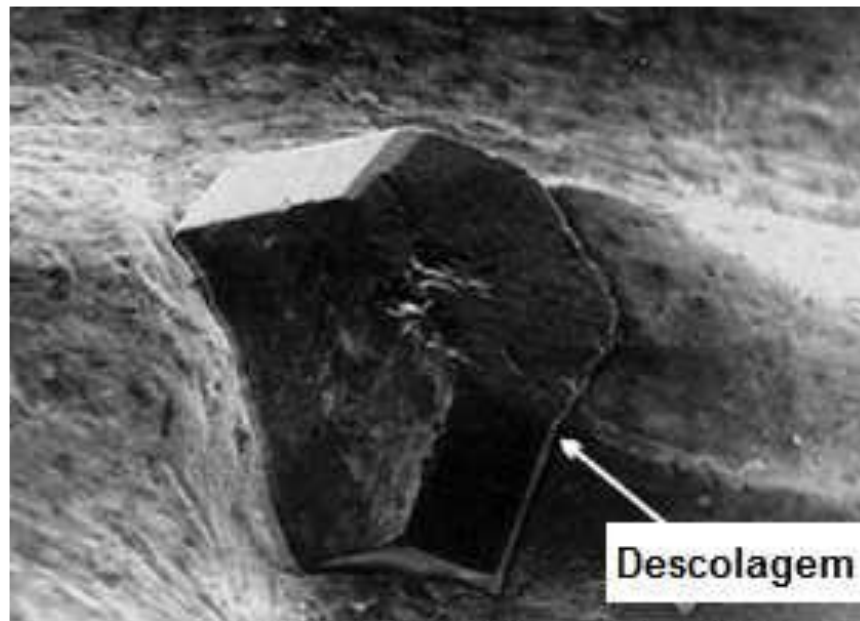
Figura 10. Micrografia mostrando um diamante descolando da superfície da matriz, após processo de corte (Junior, 2013).
