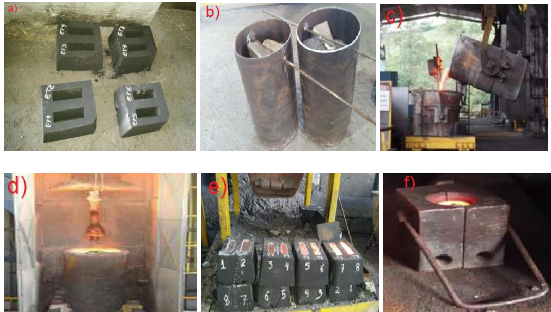
Figura 33 - a) Preparação dos moldes, b) Fe-Si e Mg, c) Vazamento do metal na panela de tratamento e início da inoculação, d) Nodulização e pós inoculação, e) Moldes de areia preenchidos com o banho metálico f) Molde metálico contendo o banho metálico para análise química
