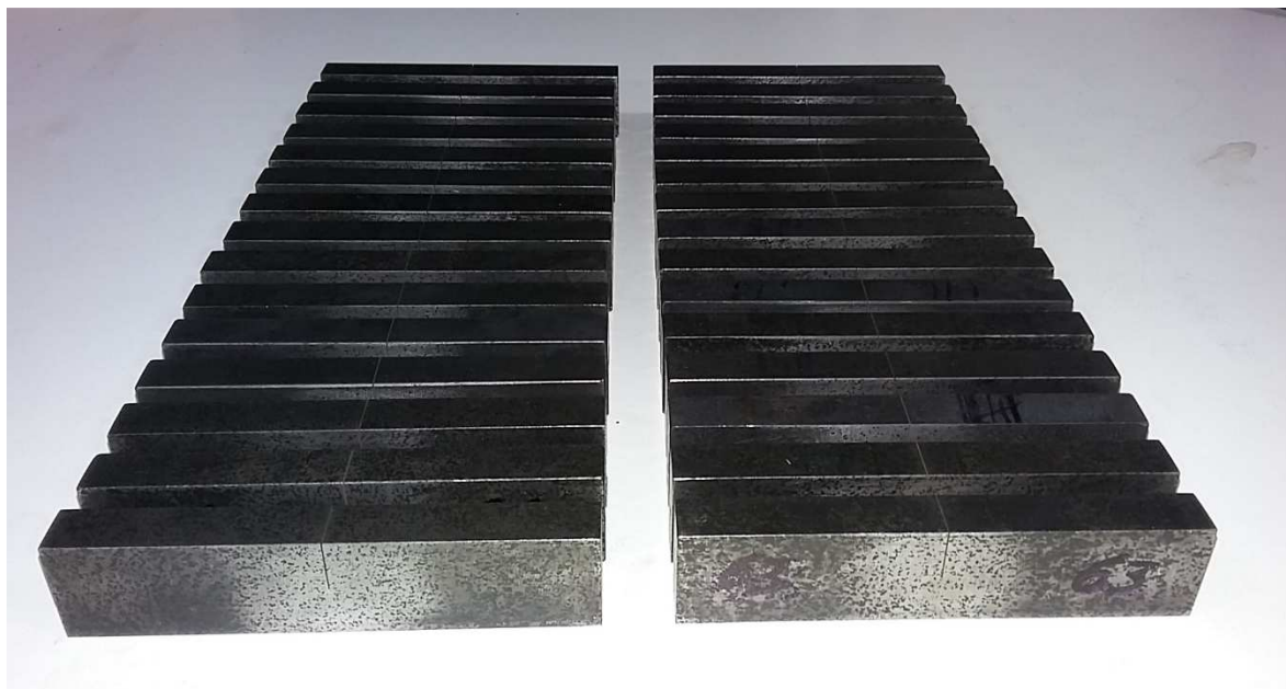
Figura 28 – Fotografia dos CPs do tipo SE(B), com entalhe em “U”.
