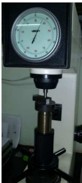
Figura 45 – Durômetro do Laboratório de END do IFF com a amostra posicionada.
