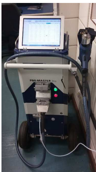
Figura 19 - Espectrômetro Oxford Instruments PMI-MASTER-Pro, série 13R0123.
