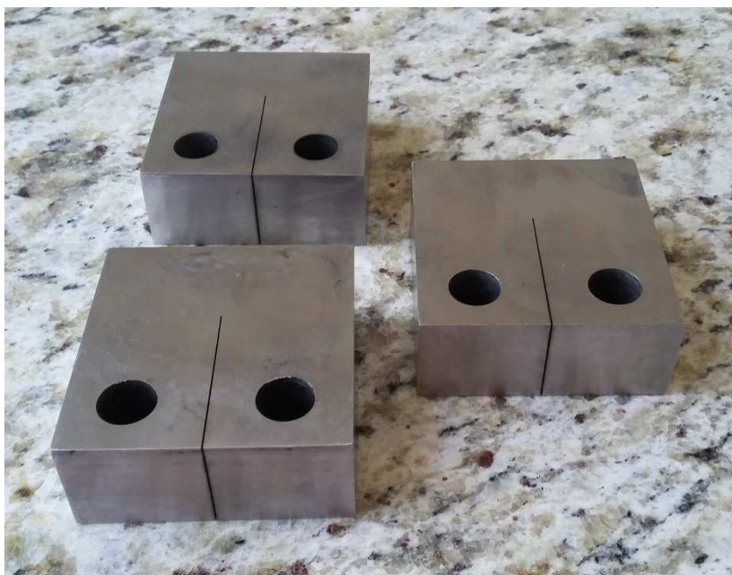
Figura 23 – Fotografia dos CPs do tipo C(T), com entalhe em “U”.
