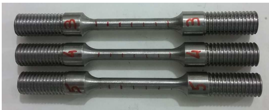
Figura 21 – Fotografia dos CPs de tração conforme ASTM E8M, 2015.
