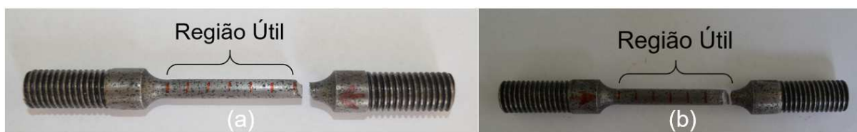
Figura 50 – CPs de tração fraturados fora da regi\u00e3o v\u00e1lida ap\u00f3s o ensaio. (a) Fotografia do CP #7. (B) Fotografia do CP #9.
