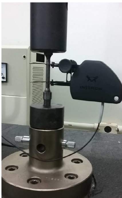
Figura 35 – CP de tração montado na Instron com garras roscadas e instrumentado com clip gage .
