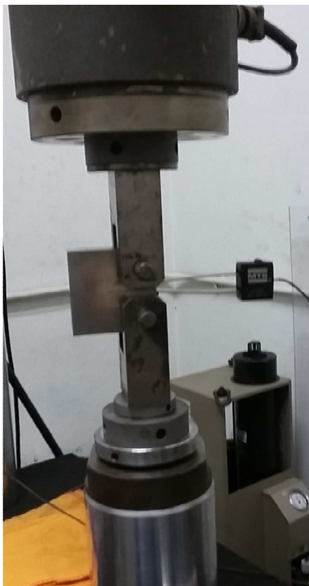
Figura 40 – CP montado nas garras da Instron com o clip gage .
