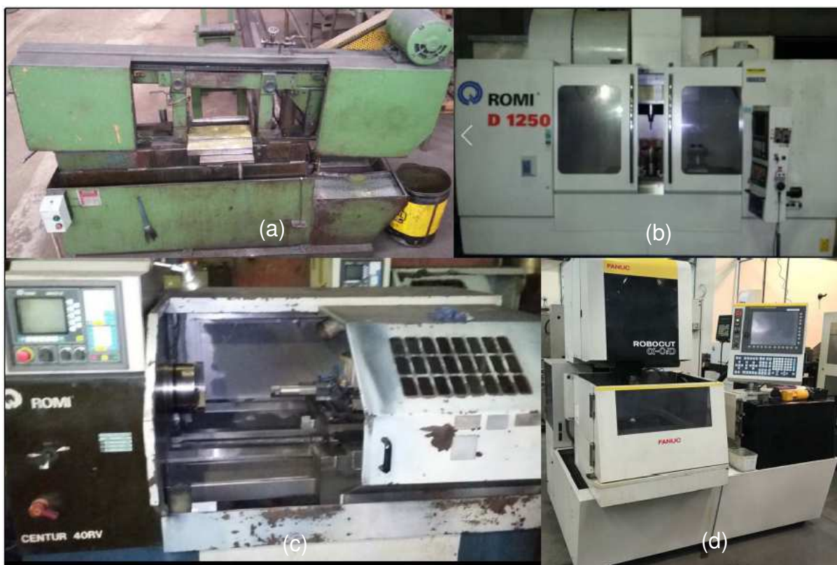
Figura 18 – Máquinas utilizadas no processo de fabricação dos corpos de prova. (a) Serra fita, modelo FM500, Franho. (b) Centro de usinagem CNC, Discovery D1250, Romi. (c) Torno CNC, Centur 40RV, Romi. (d) Eletroerosão a fio CNC, Robocut, Fanuc.
