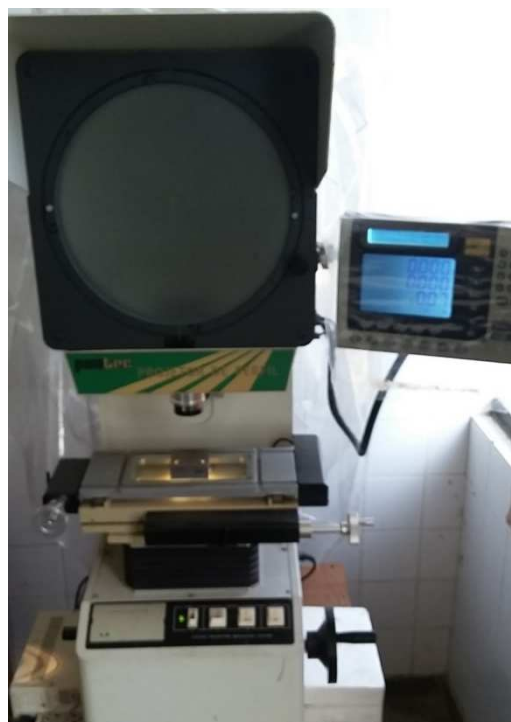
Figura 30 – Projetor de perfil PANTEC do LAMAV/UENF.
