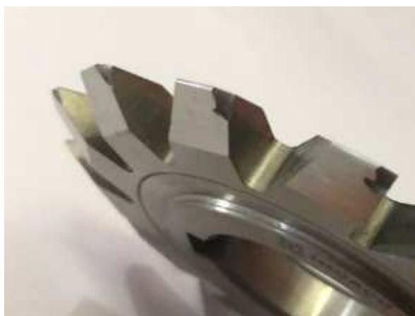
Figura 66 – Fotografia mostrando o desgaste na aresta de corte (perfil “V”).
