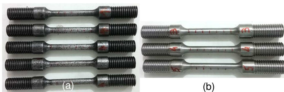
Figura 33 – CPs de tração. (a) Com tratamento térmico de têmpera e revenido. (b) Com tratamento térmico de normalização.
