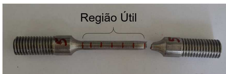
Figura 57 – CP #5 de tra\c{c}\~ao fraturado fora da regi\~ao v\~alida.
