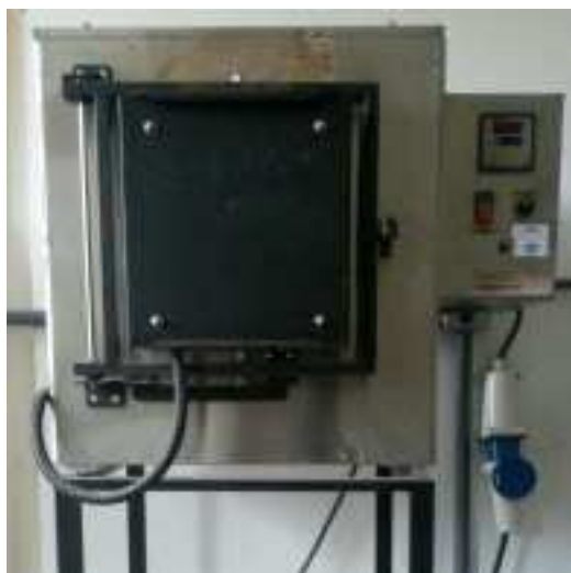
Figura 29 – Forno Mufla, FL-1300/10, MAITEC/INT.
