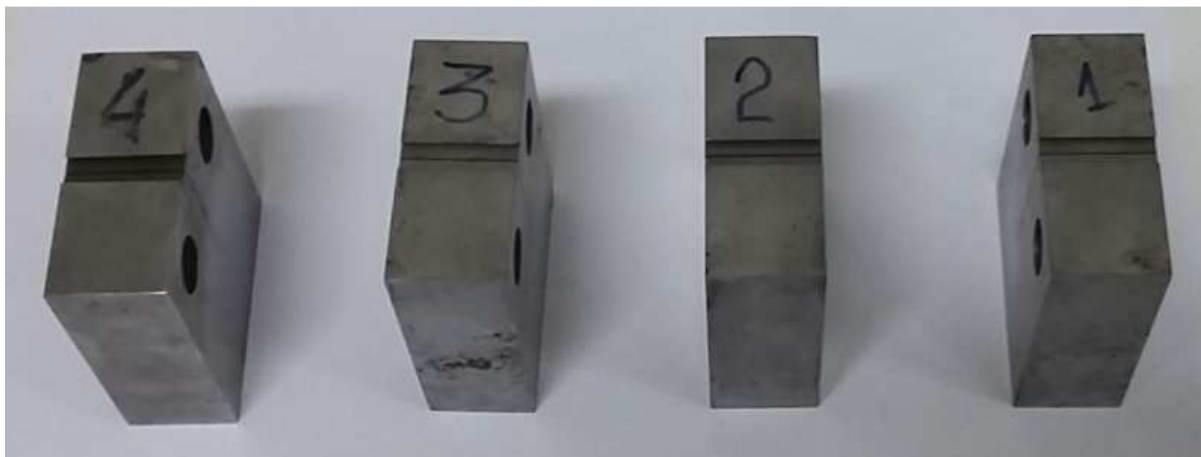
Figura 36 – Fotografia dos CPs do tipo C(T), temperado e revenido antes de serem ensaiados.
