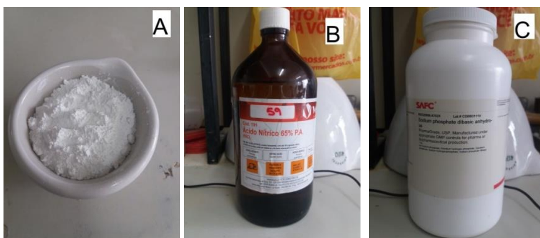
Figura 3.2. Matérias-primas utilizadas na preparação dos biocimentos. (A) resíduo pó de mármore, (B) Ácido Nítrico ( \text{HNO}_3 ) e (C) Fosfato Dissódico ( \text{Na}_2\text{HPO}_4 ).
