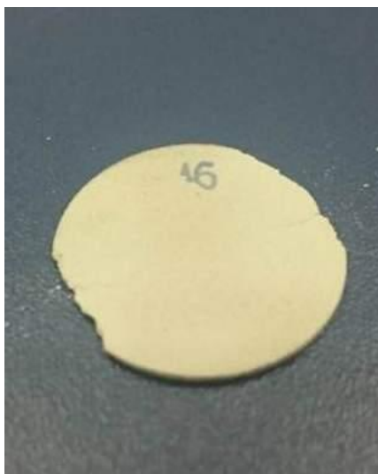
Figura 3.5- Peça de silicato de cálcio utilizada para a análise térmica.
