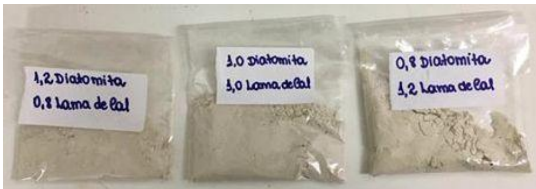
Figura 3.4 – Material de silicato de cálcio sintetizado a partir da mistura de diatomita e resíduo lama de cal.
