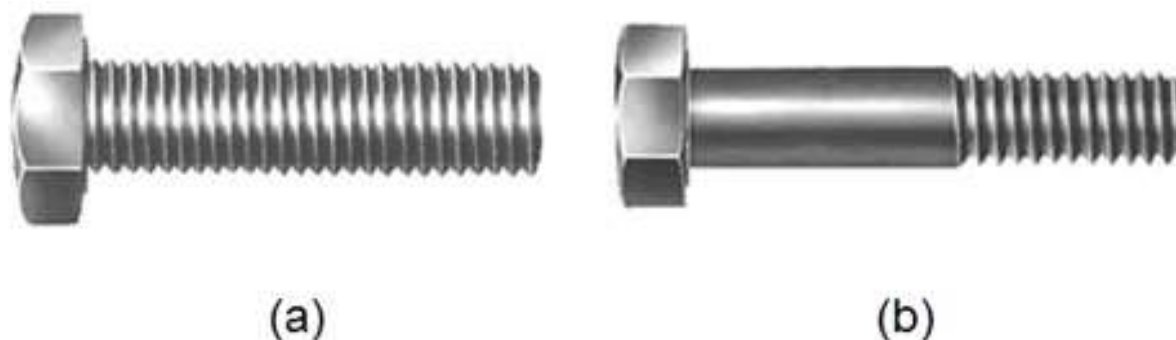
Figura 2.7 - Parafuso sextavado com rosca inteira (a) e com rosca parcial (b) (Fonte: Aragão, 2017).
