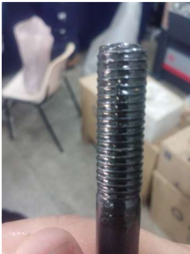
Figura 3.18 - Parafuso classe M12 x 1,75 com o trecho rosqueado lubrificado com graxa Lubrax Autolith 2.
