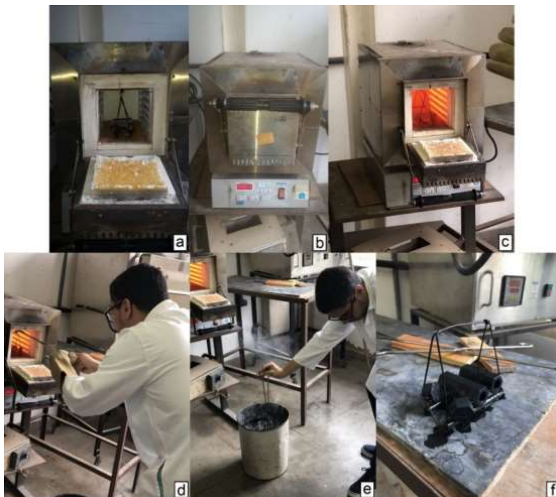
Figura 3.4 - Sequência do tratamento de têmpera: colocação da cesta metálica com as matrizes de aperto e os corpos de prova (a), aquecimento na temperatura e no tempo programados (b), abertura do forno (c), retirada da cesta do forno (d), mergulho da cesta no óleo de têmpera HYDRATEMP AC (e), matrizes e corpos de prova temperados (f).
