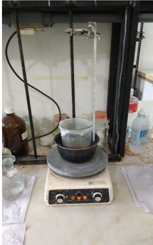
Figura 18 – Lavagem das fibras de bagaço de cana-de-açúcar com água destilada à temperatura de 80^{\circ}\text{C} \pm 2^{\circ}\text{C} por 1 hora.
