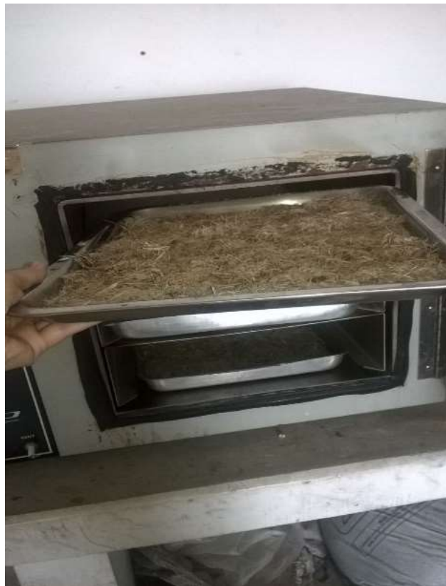
Figura 15 – Secagem em estufa das fibras do bagaço de cana-de-açúcar.
