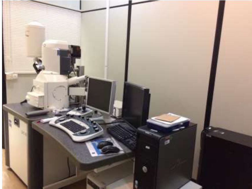
Figura 20 – Microscópio eletrônico de varredura (MEV) modelo ZEISS EVO 40.
