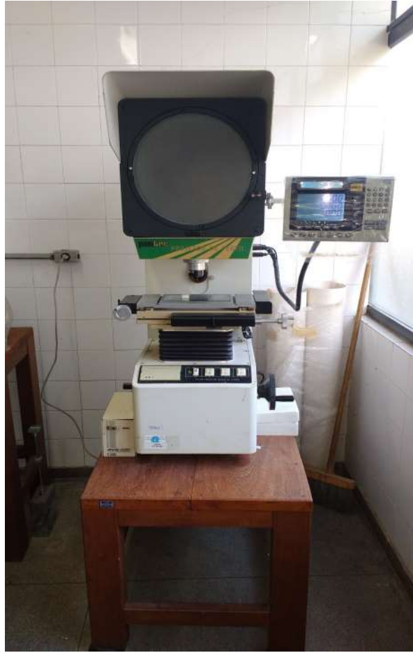
Figura 17 – Projetor de Perfil utilizado para a medição do diâmetro das fibras.
