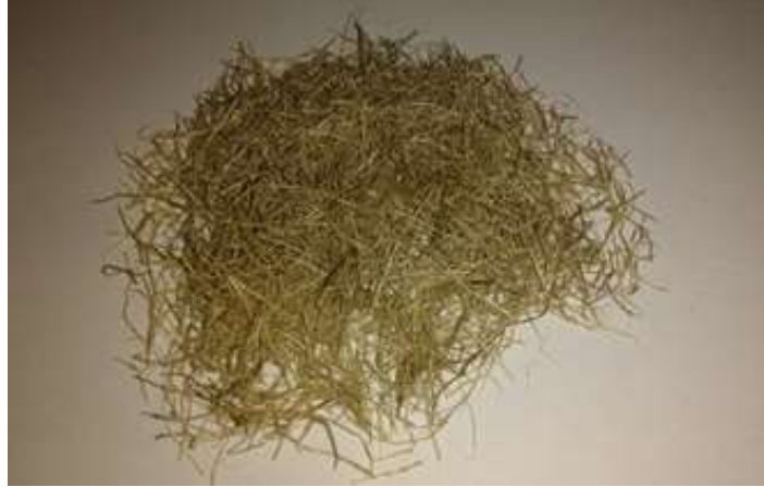
Figura 16 – Fibras de bagaço de cana-de-açúcar selecionadas.
